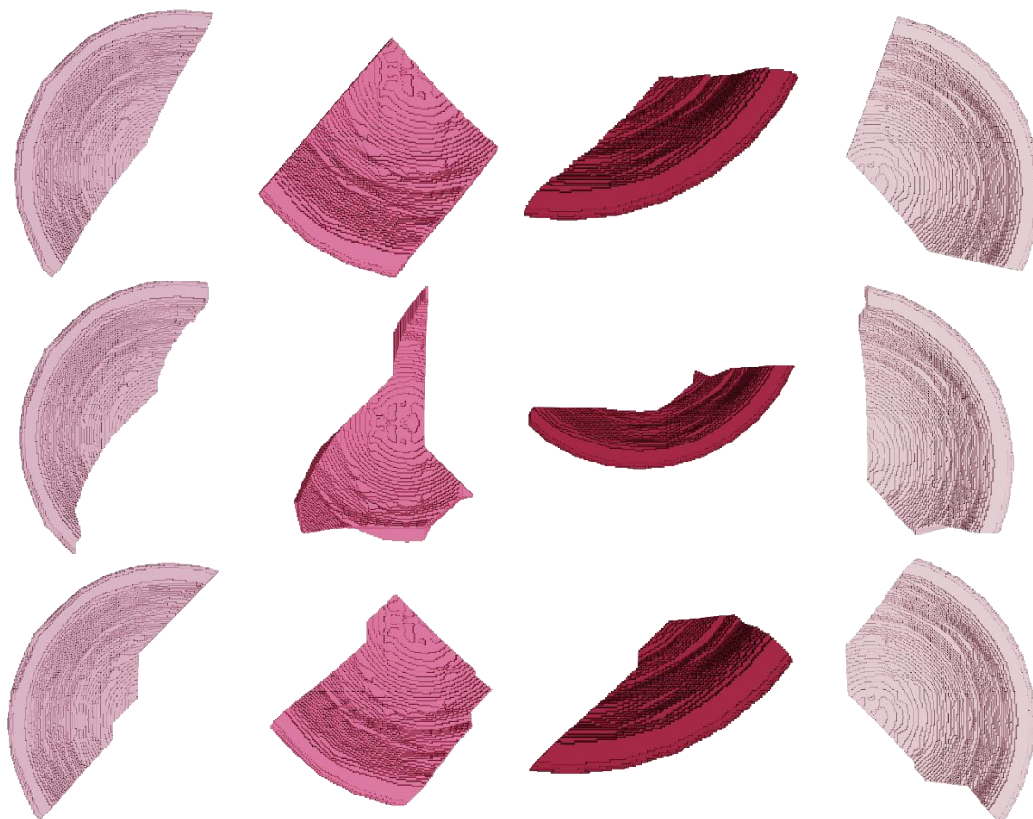
Ilustración 7.3. Comparación de fragmentos generados utilizando tres métricas de distancia: arriba, euclidiana; en medio, manhattan; y abajo, chebyshev. Los fragmentos han sido generados utilizando las mismas semillas.
