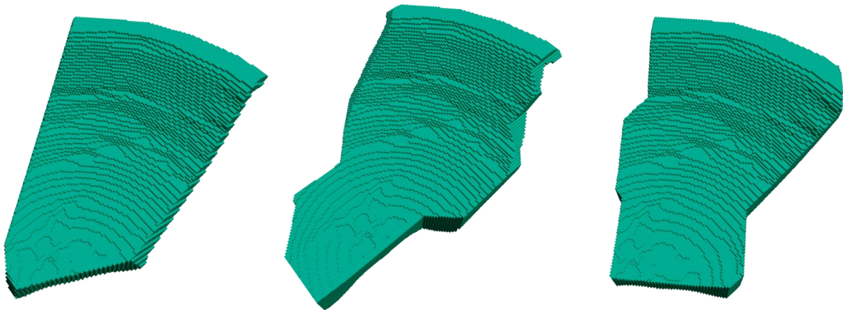
Ilustración 4.7. Mismo fragmento 3D generado utilizando tres métricas distintas. Respectivamente: euclidiana, manhattan y chebyshev.
