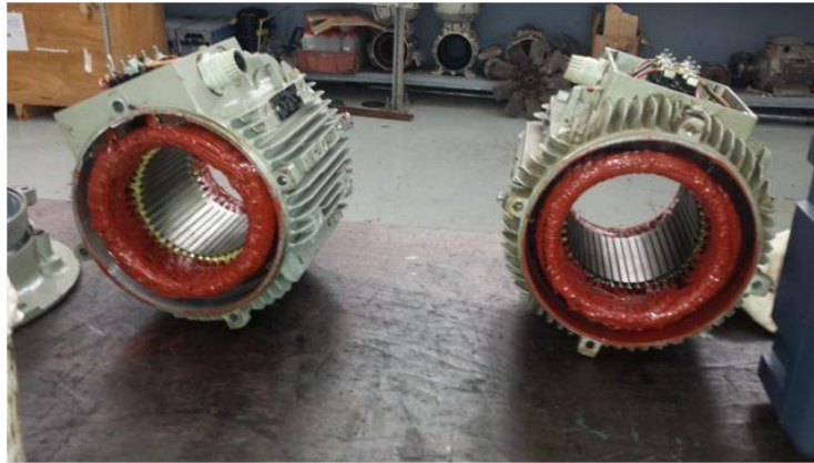
Figura 8. 23-Mantenimiento de los motores Aero refrigerante.
