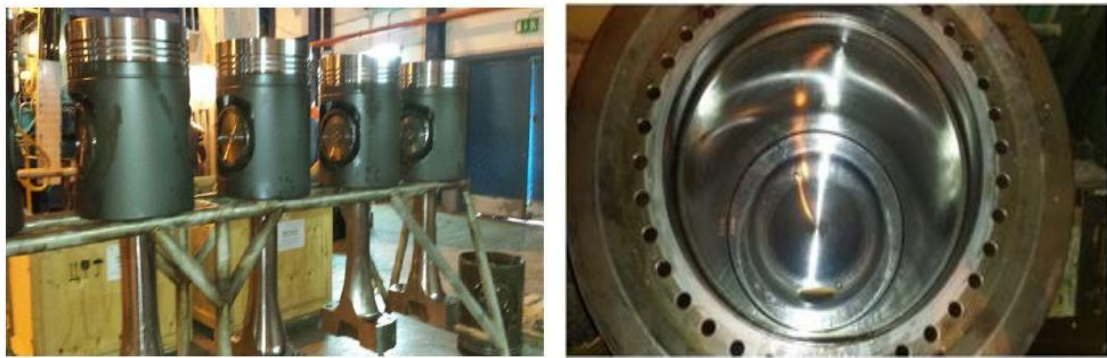
Figura 8. 9-Limpieza de los pistones.
