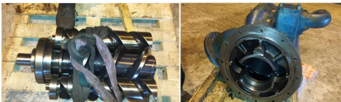
Figura 8. 1- Limpieza de la bomba de aceite
