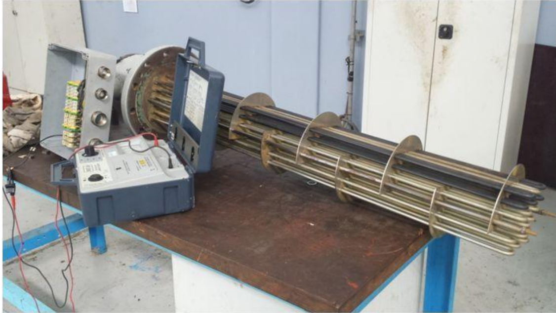
Figura 8. 29-Mantenimiento de la unidad de las resistencias del precalentamiento.
