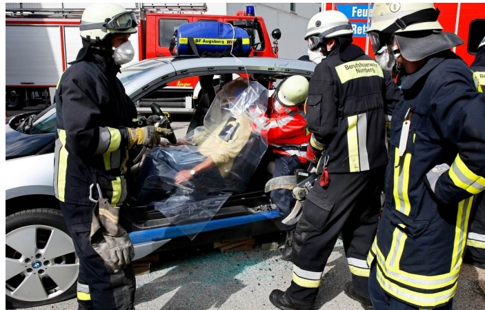
Figura 34: Simulacro de excarcelación de un herido en un coche de fibra de carbono. El personal de asistencia equipa gafas de protección y mascarillas y protege a la víctima haciéndole respirar aire no contaminado (con los útiles sobre el techo del coche) y cubriéndolo completamente con un film plástico para evitar contacto con fibras de carbono.
