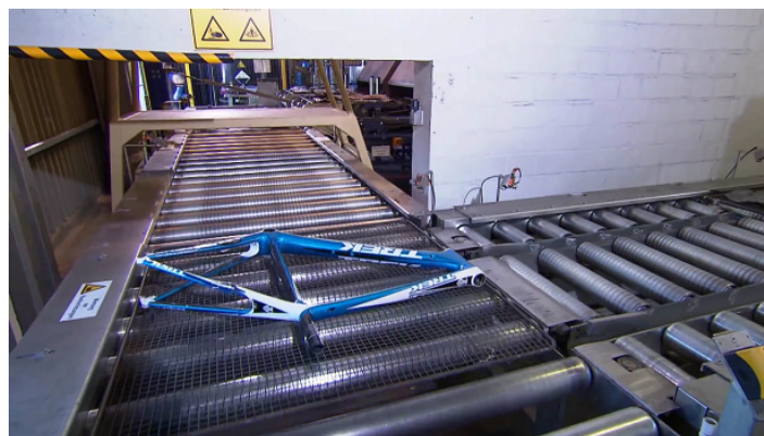
Figura 17: Cuadro de bicicleta de CFRP dañado, camino del horno pirólítico.
