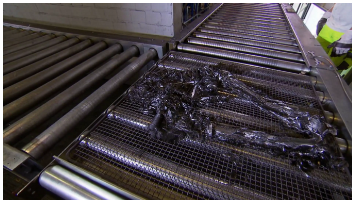
Figura 19: Fibras de carbono recuperadas del cuadro de bicicleta, una vez terminado el proceso de pirólisis.
