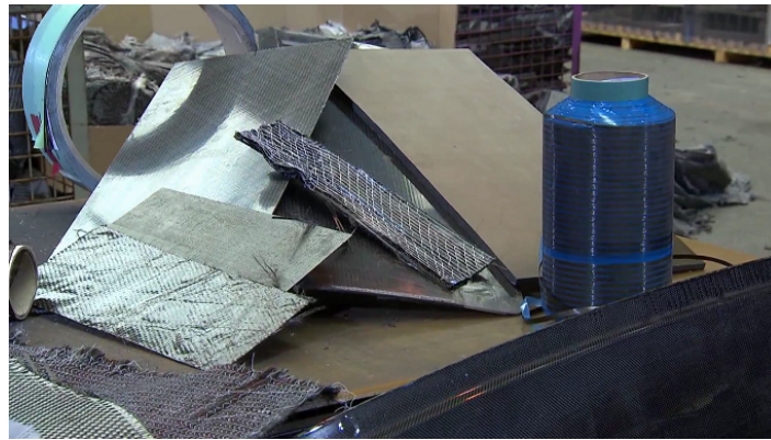
Figura 16: Residuos de fibra de carbono: prepeg, tejidos, CFRP formados, paneles sándwich...
