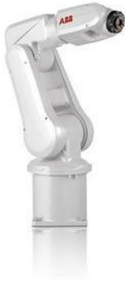
Figura 24. Brazo robótico ABB IRB 120. [17]
