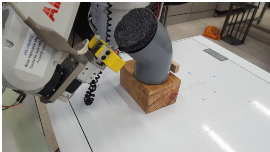
Figura 83. Soldadura 2. Final del recorrido de la primera parte a soldar.
