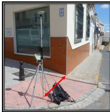
Figura IV.1. Ejemplo de estacionamiento de antena receptora
