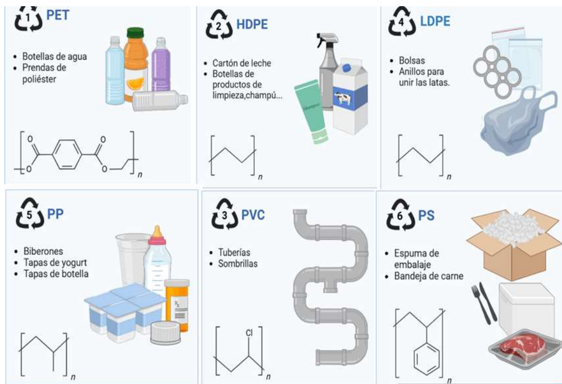
Figura 4. Clasificación de los plásticos y su estructura. Imagen obtenida por Elena González López en biorender. https://app.biorender.com/biorender-templates/figures/all/t-
