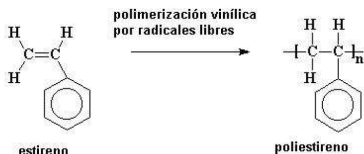
Figura 8. Reacción de polimerización del estireno para la obtención del poliestireno. https://tecnologiadelosplasticos.blogspot.com/2011/06/poliestireno.html .
