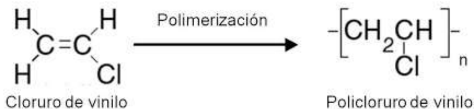
Figura 7. Reacción de polimerización del cloruro de vinilo para la obtención de PVC. http://blog.pucp.edu.pe/blog/quimicageneral/quimica-1/unidad-8-materiales-modernos/8-2-polimeros/
