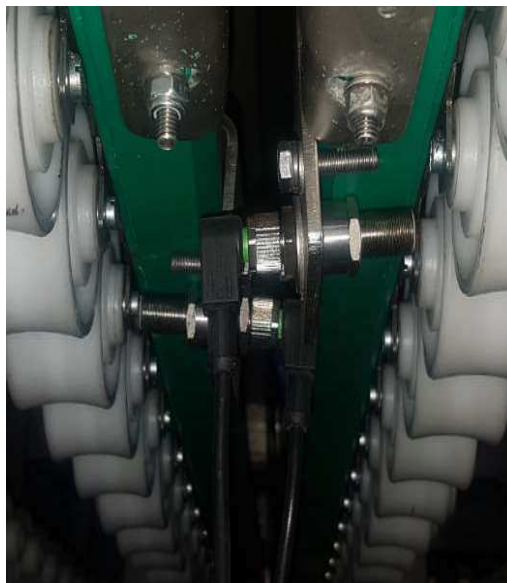
Figura 2.6. Sensor inductivo vista interior
