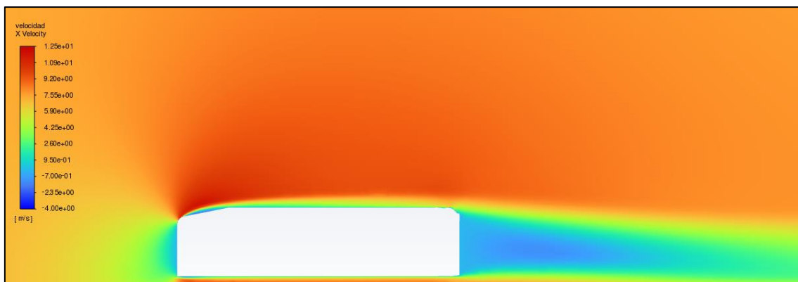
Ilustración 84: Isocontorno de velocidades en x del modelo 2 a Re=20.000 (trasera vertical).
