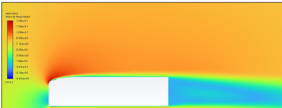
Ilustración 75: Isocontorno de velocidades en x del modelo 2 a Re=20.000 (capitoné).
