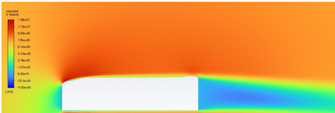
Ilustración 103: Isocontorno de velocidades en x del modelo 2 a Re=200.000 (final de caja).
