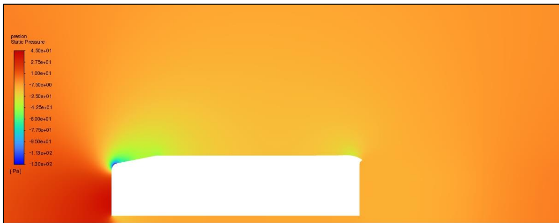
Ilustración 94: Isocontorno de presión estática del modelo 2 a \text{Re}=200.000 (trasea horizontal).
