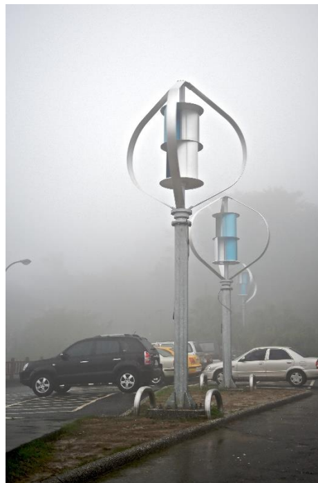
Imagen 3: Turbina mixta s-v
