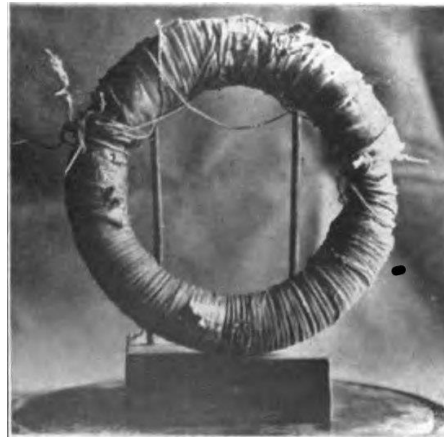
Imagen 5: El transformador de Faraday. Fuente: Wikipedia
