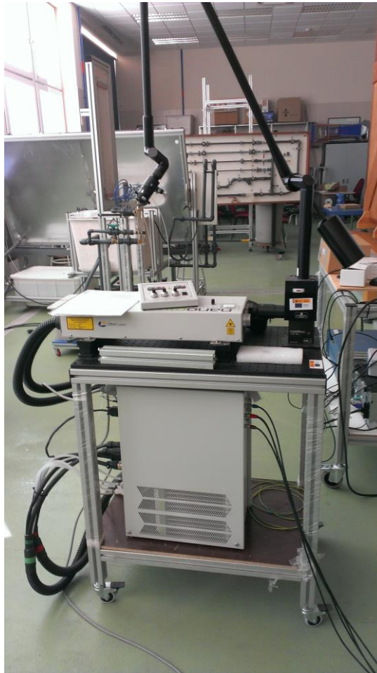
Figura 5.34: Laser YAG con equipo de refrigeración y ópticas
