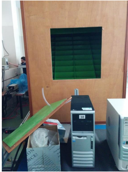
Figura 7.4: Desprendimiento de la lámina de madera.
