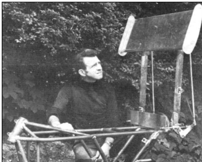
Figura 3.29: Colin Lyster con un prototipo de alerón para motocicletas (Tony Foale)
