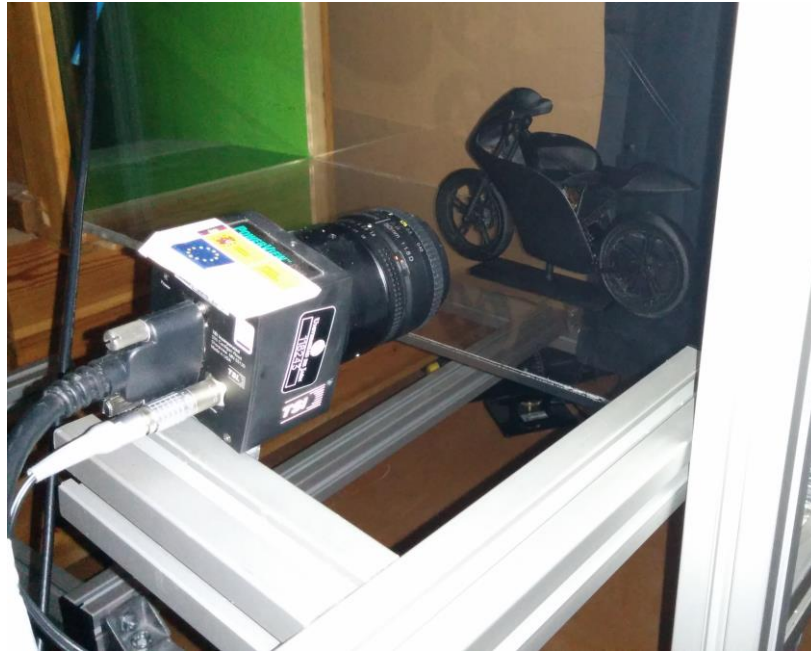
Figura 5.39: Colocación de la cámara y el modelo en el túnel de viento
