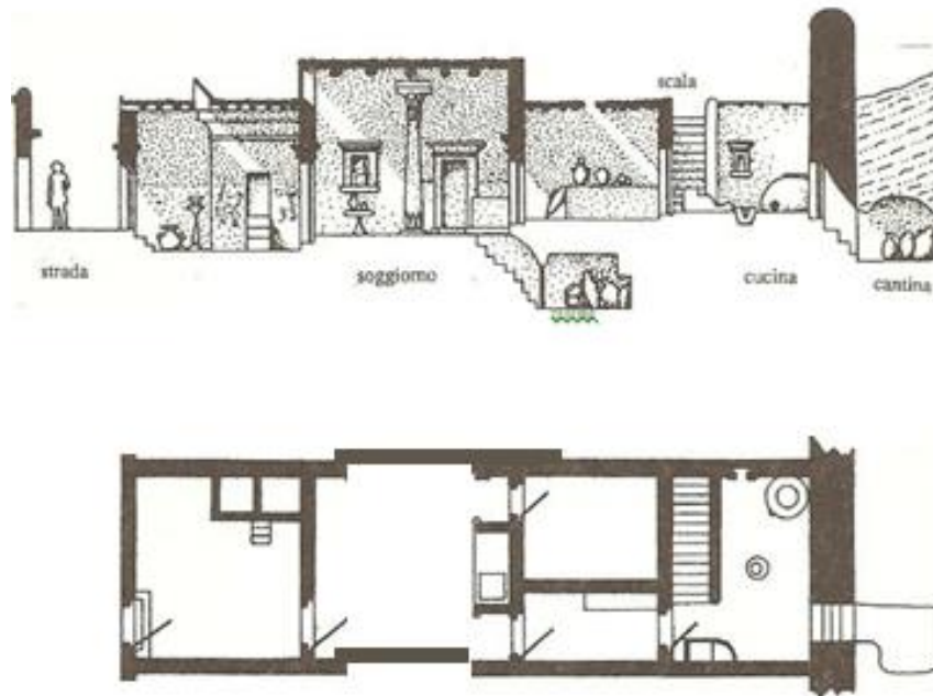
Figura 8. Sección y plano de una casa en Deir el-Medina.
