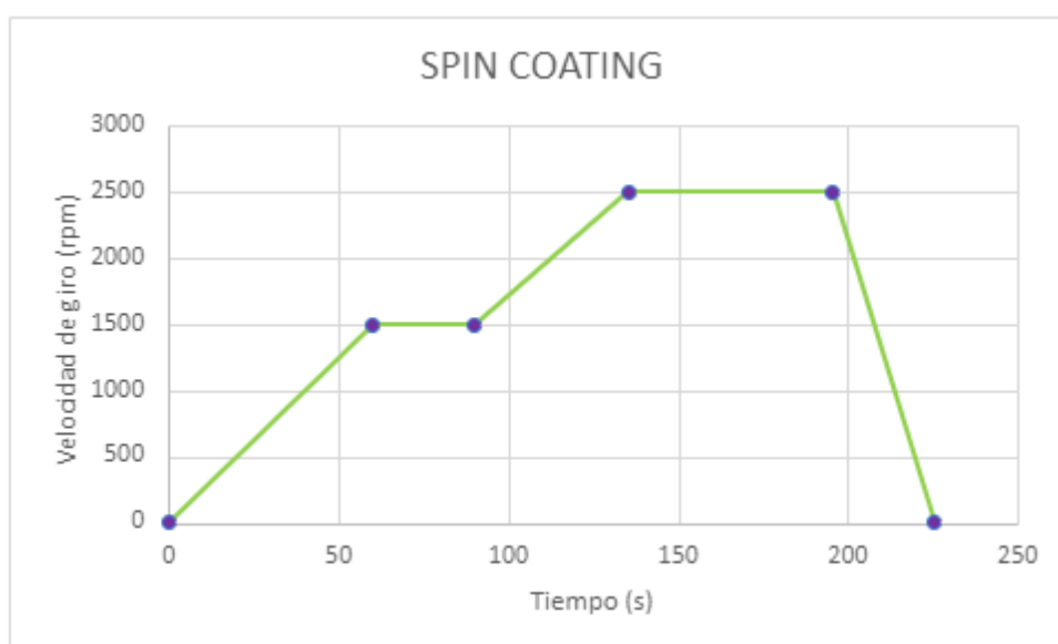
Gráfica 1: Representación del método de trabajo de Spin Coating
