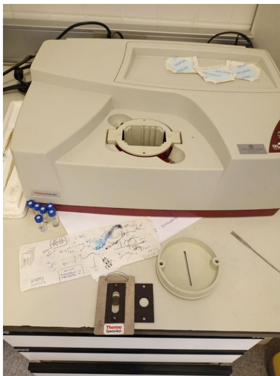
Ilustración 43: Espectro de infrarrojo junto portasustancias con una pastilla de muestra de Qdot sólido
