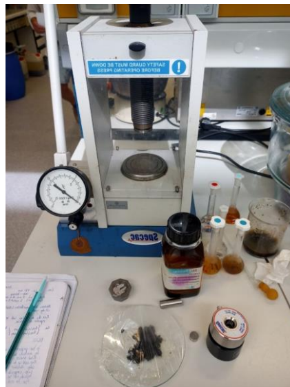
Ilustración 14: Prensa y material para realizar las pastillas de infrarrojo
