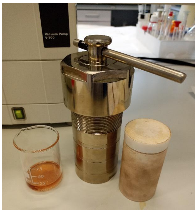
Ilustración 30: Reactor y muestra para síntesis hidrotermal
