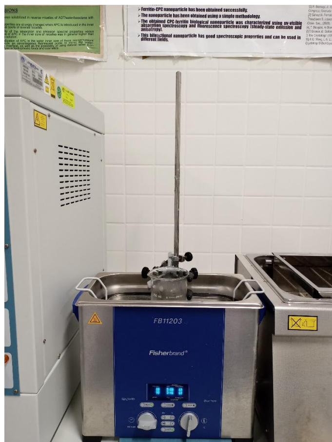
Ilustración 18: Baño de ultrasonido de la mezcla
