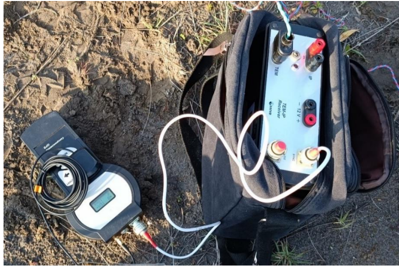
Figura 2. 45. GPS conectado a la antena y al receptor.
