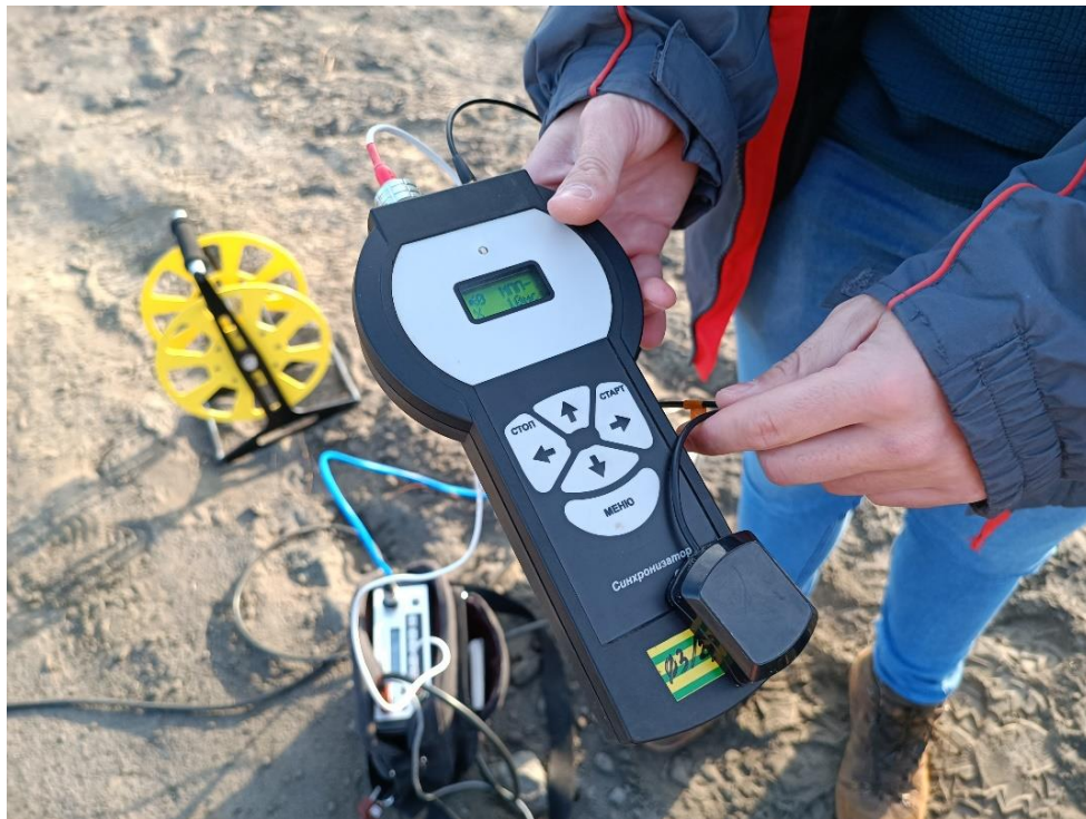
Figura 2. 48. Conexión GPS al Transmisor
