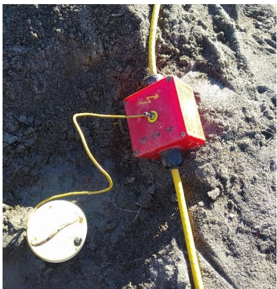
Figura 2. 6. Electrodo enchufado al conector
