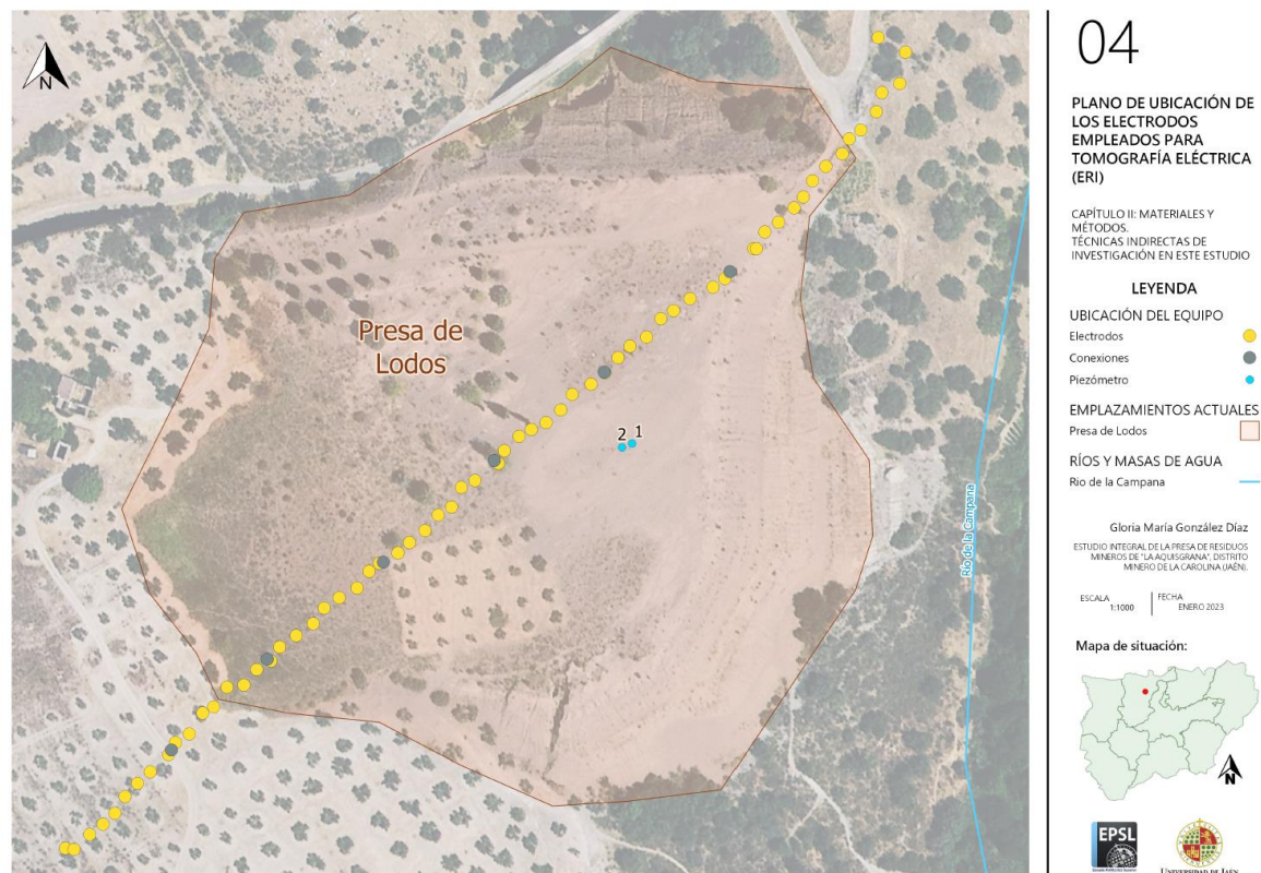
Figura 2. 10. Plano de ubicación de los electrodos empleados para Tomografía Eléctrica (ERI)
