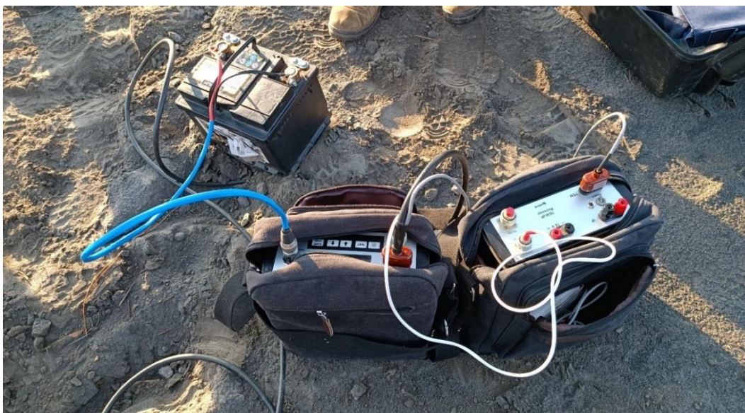
Figura 2. 47. Conexión de equipos para bucle único
