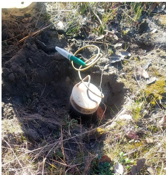
Figura 2. 4. Electrodo Impolarizable ("potito")
