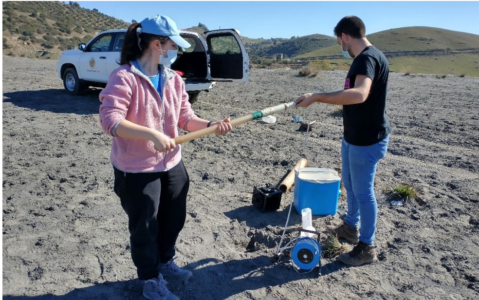
Figura 3. 15. Recogida de muestras de agua en el sondeo mecánico.
