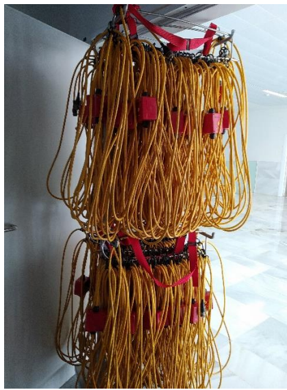
Figura 2. 5. Cable multinúcleo tipo sísmico
