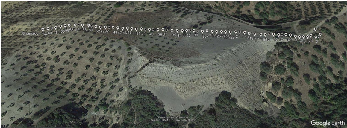
Figura 4. 1. Ubicación de los electrodos en 3D (punto de vista de la gráfica obtenida por Tomografía Eléctrica).
