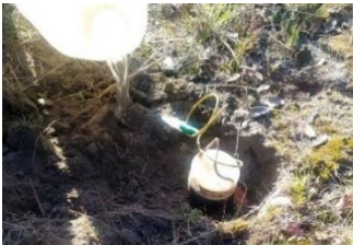
Figura 3. 4. Regado del electrodo.
