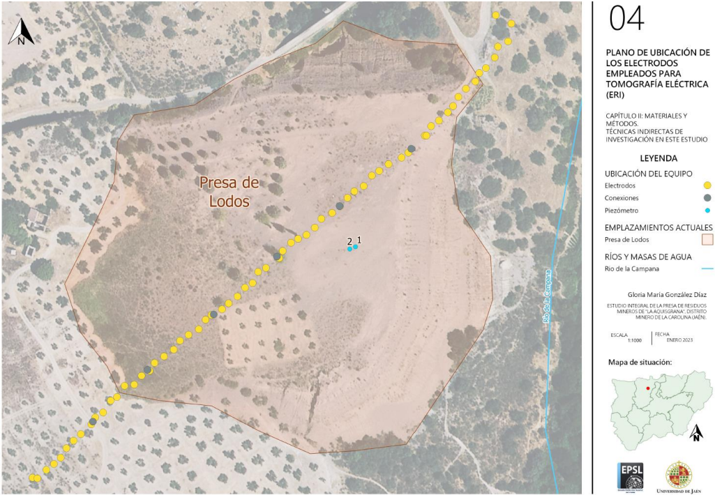
Figura 3. 1. Plano de ubicación de los electrodos empleados para Tomografía Eléctrica (ERI)
