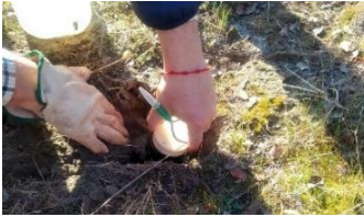
Figura 3. 2. Implantación del electrodo.
