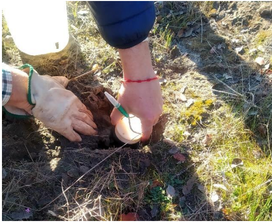
Figura 2. 11. Excavación e implantación del electrodo.
