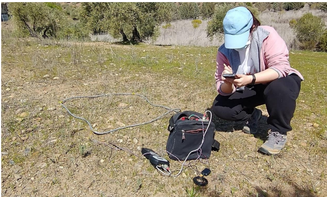
Figura 3. 22. Configuración y toma de medidas para bucle centrado.
