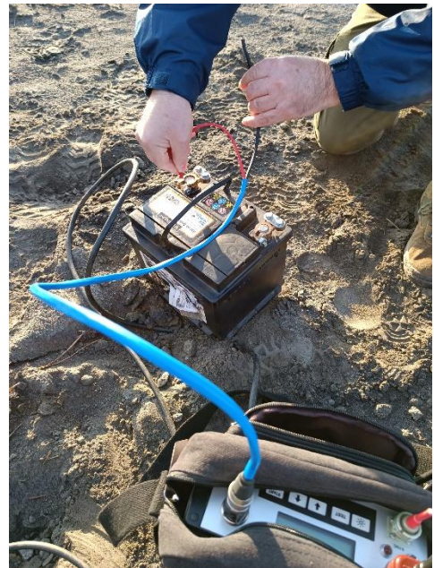
Figura 2. 42. Conexión de batería
