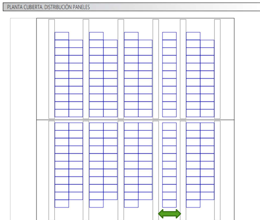
Ilustración 15: Lucernarios con menos separación
