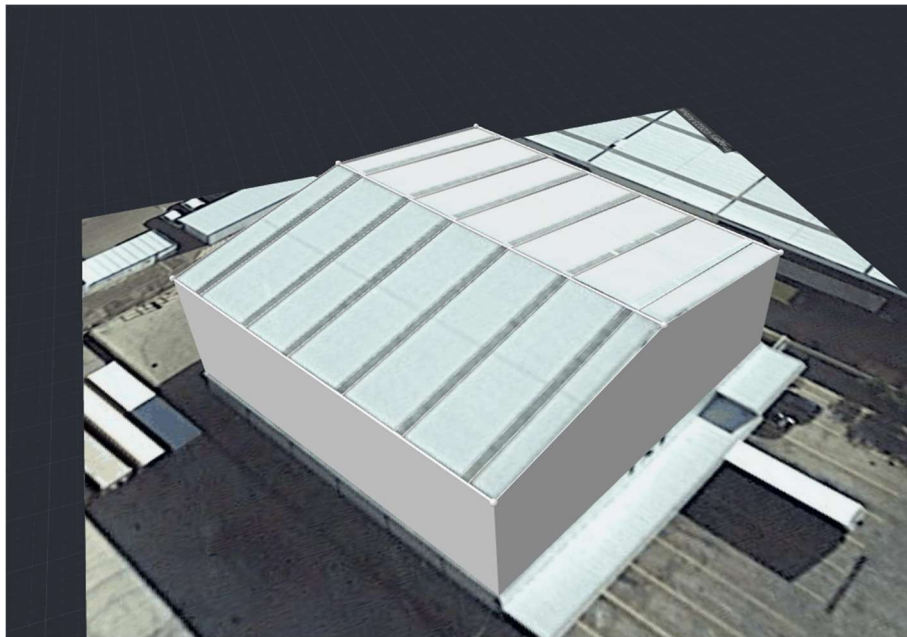
Ilustración 5: Nave industrial modelada en 3D En SolarEdge Designer
