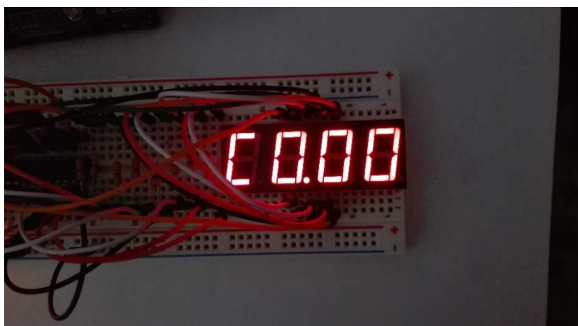
Figura 43. Display mostrando el ciclo de trabajo
