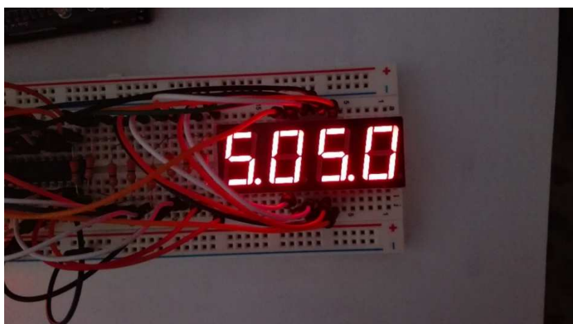
Figura 44. Display mostrando la tensión de referencia
