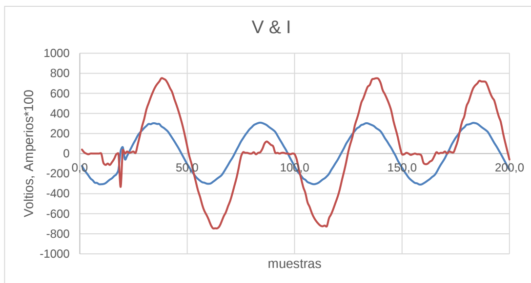
Ilustración 133 Gráfica tensión e intensidad de impresora en carga.
