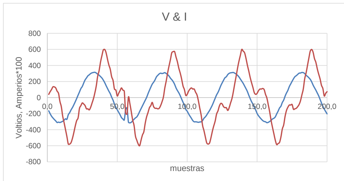
Ilustración 91 Gráfica tensión e intensidad de sierra de cinta.
