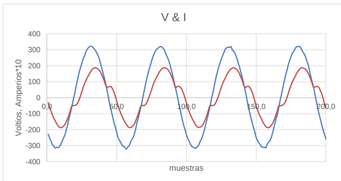
Ilustración 61 Grafica tensión e intensidad microondas + Grill.
