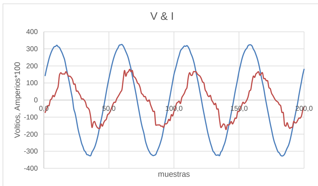
Ilustración 43 Grafica tensión e intensidad frigorífico.
