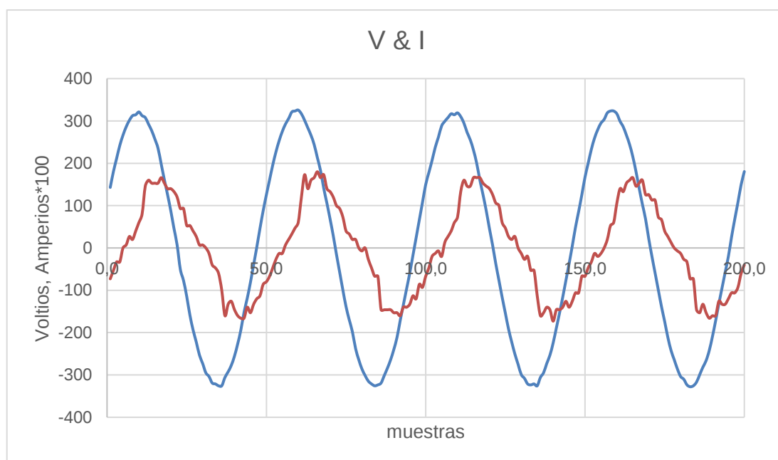
Ilustración 49 Grafica tensión e intensidad tostador.
