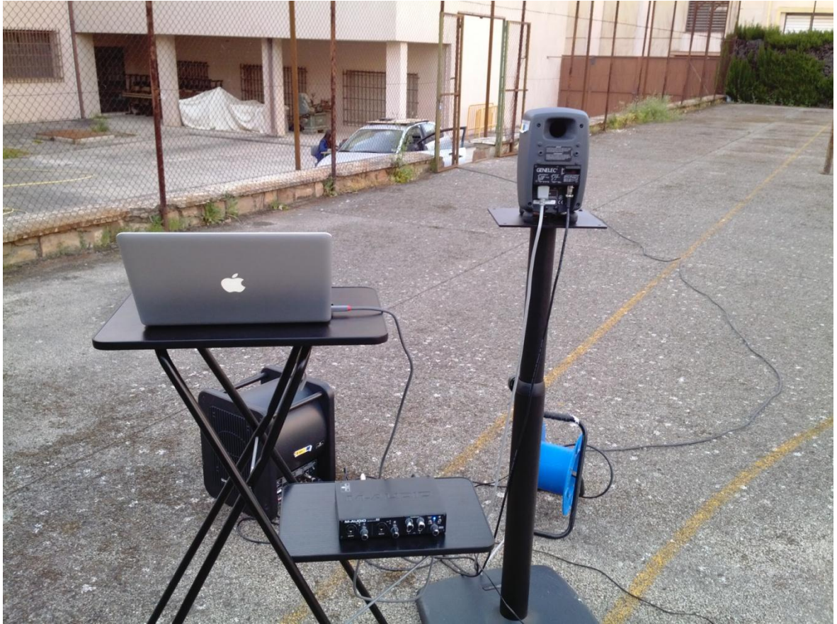
Figura 37. Equipos encargados de la reproducción de la fuente sonora producida por un arma de fuego.
