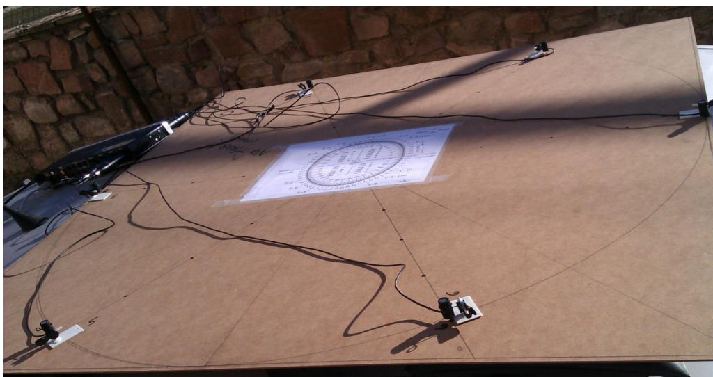
Figura 32. Tablero para la simulación de un array circular de 1 metro de diámetro formado por seis micrófonos.
