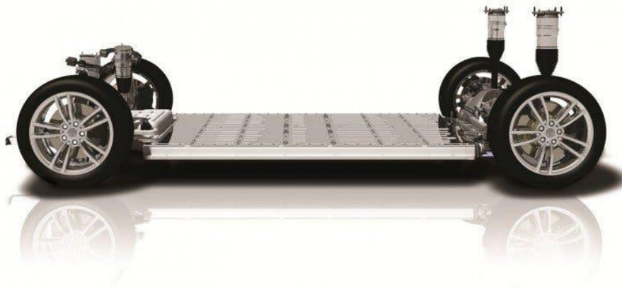
Chasis y baterías del Tesla model S (híbridos eléctricos)
