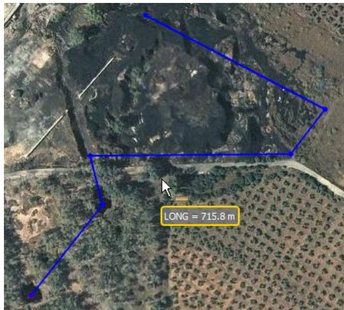
Figura 17: Posición y longitud drenaje lixiviados
