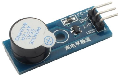
Figura 22. Buzzer. Módulo de sonido pasivo de bajo nivel
