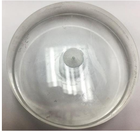
Figura 21. Disco orificio con superficie de Neverwet realizada.
