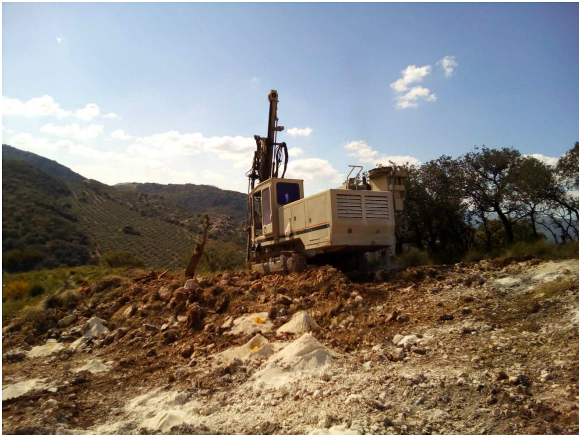
FIG 1.2.8. equipo de perforación y barrenos
