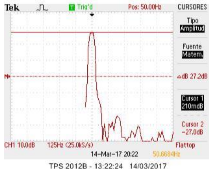
Figura 78. Medida con cursores de la amplitud del armónico fundamental de la onda senoidal
