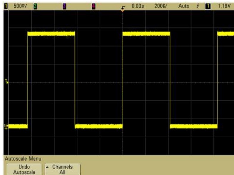
Fig. 12. Onda resultante al conectar a PROBE COMP [3]
