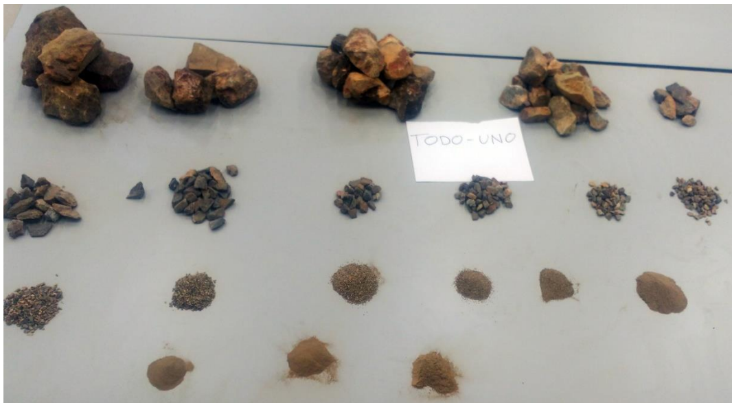
Imagen 2.3. Clasificación granulométrica visual del todo-uno.
