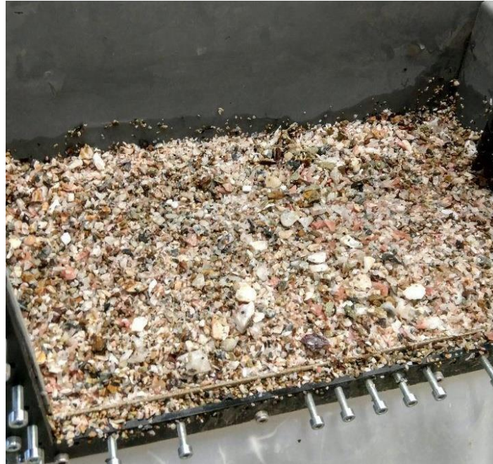
Imagen 2.13. Tercer preconcentrado. Fracción gruesa de mineral una vez retirado el estéril
