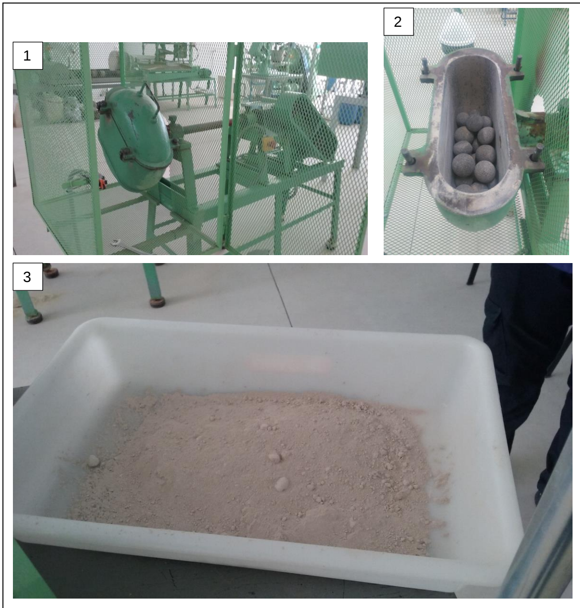
Imagen 2.26. Molienda (1.- molino de bolas de carcasa cerrada del laboratorio; 2.- bolas del molino; 3.- producto molido)
