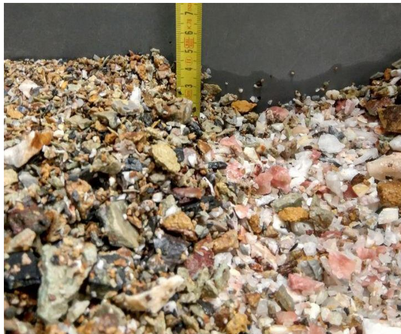
Imagen 2.12. Tercer preconcentrado. Detalle de la altura de la fracción de estéril sobre el mineral
