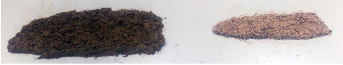
Imagen 2.15. Diferencia visual entre los finos obtenidos en el primer ensayo (imagen de la izquierda, más oscura debido al mayor porcentaje de filitas) y los finos obtenidos en el segundo ensayo tras un lavado previo (imagen de la derecha con un contenido alto de barita)
