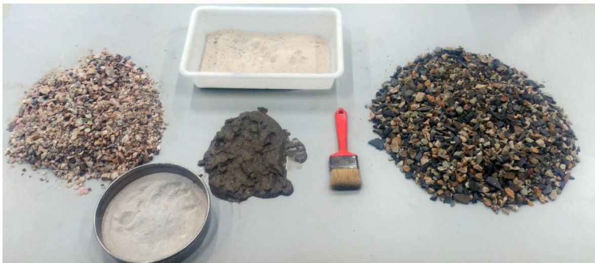
Imagen 2.28. Productos finales procedentes de los procesos de concentración (nota: el producto obtenido de la espiral se encuentra mojado, su imagen real corresponde a la imagen 2.29-1)
