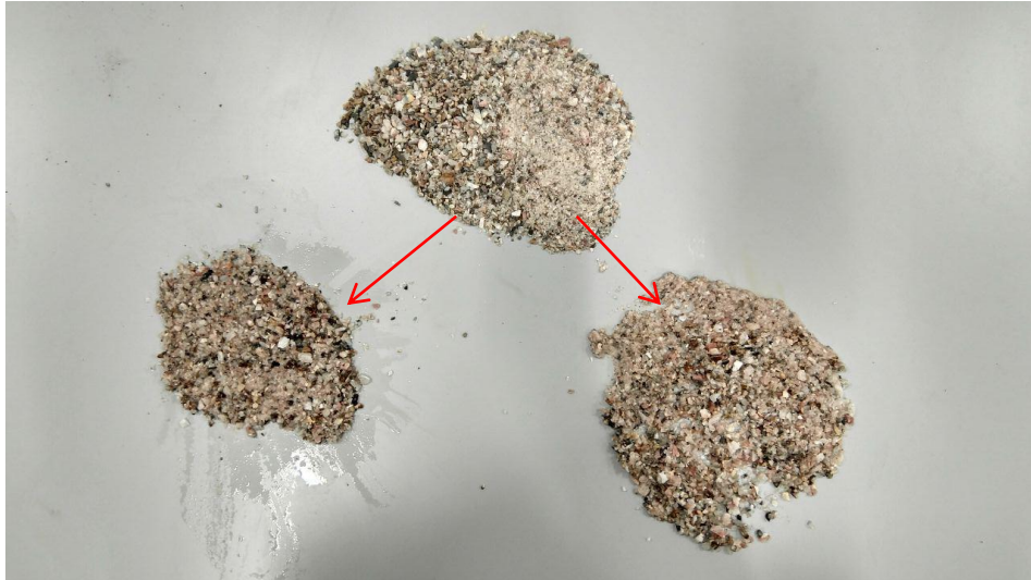
Imagen 2.16. Resultados obtenidos de las concentraciones de la misma muestra de finos. (Abajo-izquierda mesa Wilfley antigua, abajo-derecha mesa Wilfley nueva)
