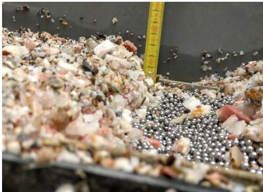
Imagen 2.14. Tercer preconcentrado. Detalle de la altura de la fracción gruesa de mineral sin estéril, sobre la cama de bolas
