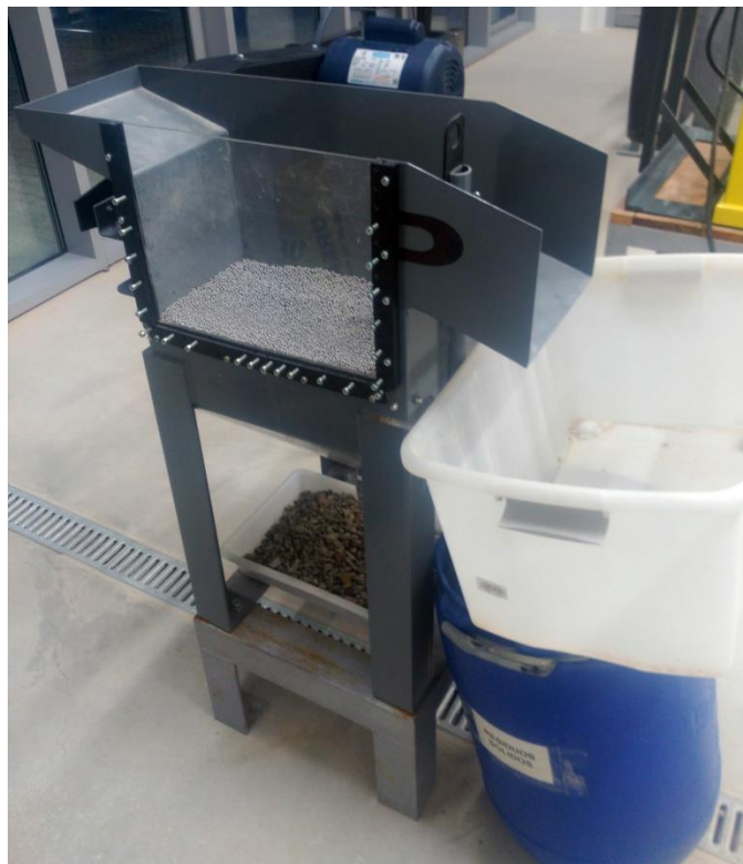
Imagen 2.8. Jig tipo Denver del laboratorio con cama de bolas de acero
