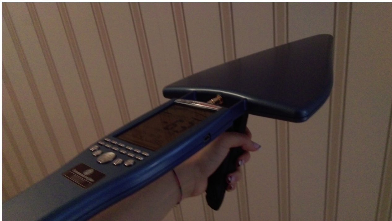
Imagen 3. Modo de uso durante las mediciones con SPECTRAN HF-2025E con antena HyperLOG y soporte incorporados.
