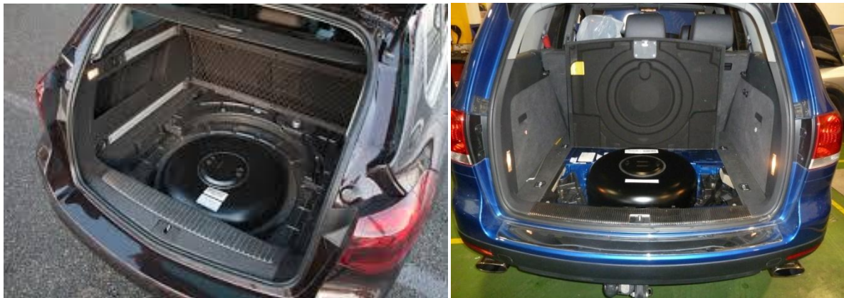
Ilustración 71. Ejemplos de tanques toroidales de GLP en el hueco de la rueda de repuesto. Fuente: Autobild
