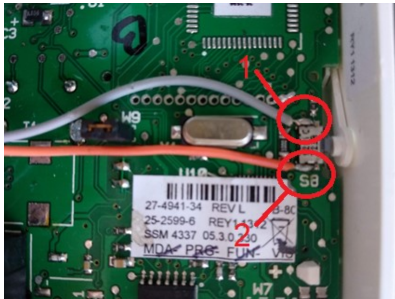
Figura 2.4 – Bypass realizado sobre el pulsador de encendido/apagado del mando NS-ATP7002
