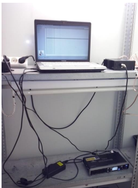
Figura 8.21: Equipo emisor de ultrasonidos al completo.
