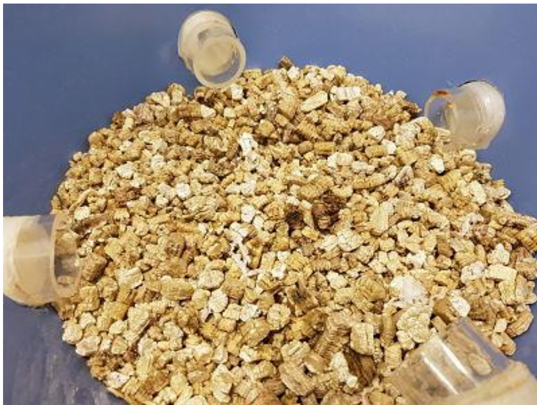
Figura 8.39 Cámara central rellena de vermiculita deshidratada.
