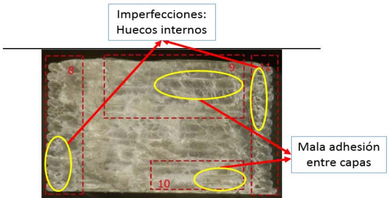
Figura 6-15 Sección transversal probeta PLA con orientación de fibra 90°. [53]
