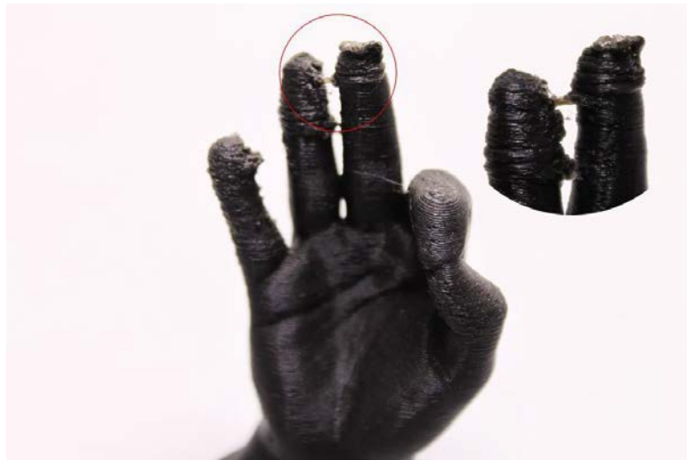
Figura 2-8 Pieza defectuosa debido a una velocidad de impresión alta. [13]
