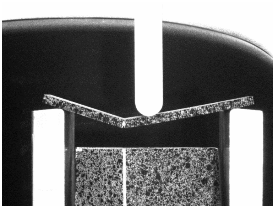
Figura 6-41 Rotura de probeta 2 PLA orientación de fibra 90°.
