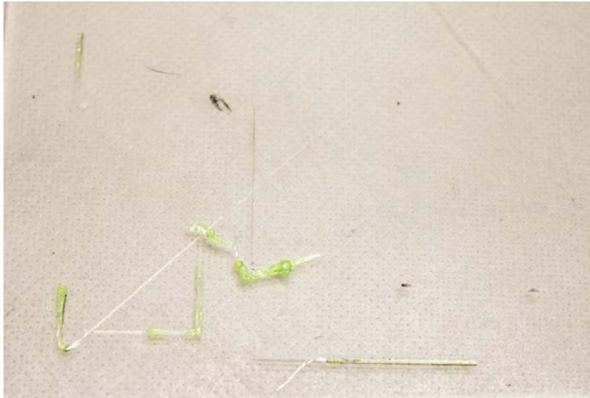
Figura 2-14 Nozzle demasiado cerca de la cama de impresión.
