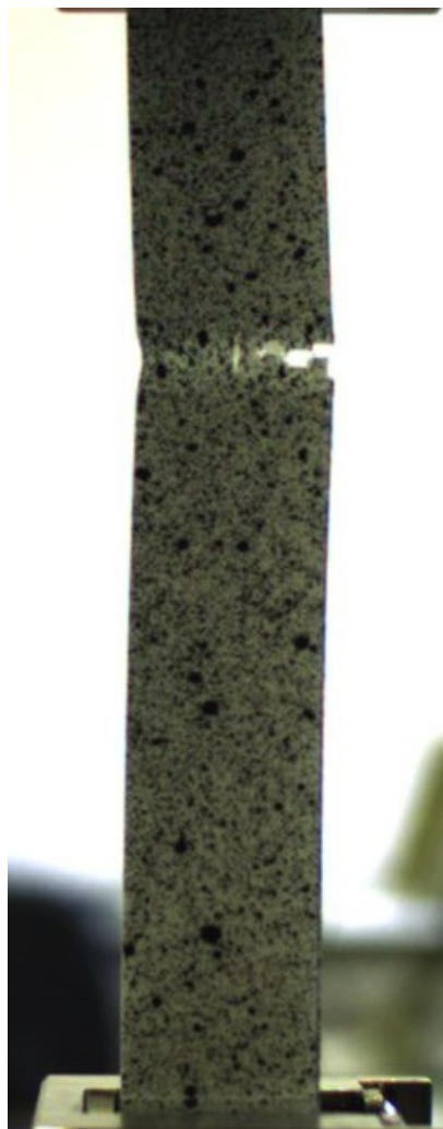
Figura 6-22 Rotura probeta 3 ABS con orientación de fibra 0°.
