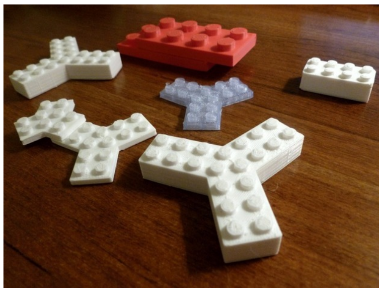
Figura 4-4 Piezas de LEGO fabricadas en ABS con tecnología FFF. [28]
