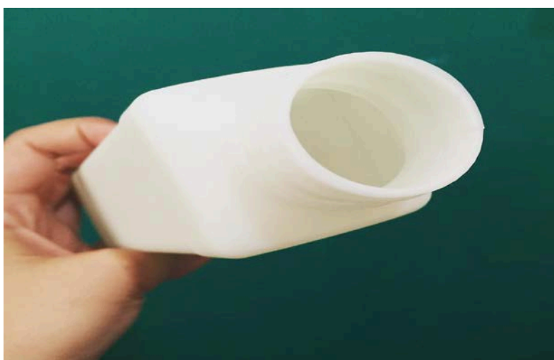
Figura 4-1 Prototipo en PLA de botella fabricada mediante tecnología FFF. [16]
