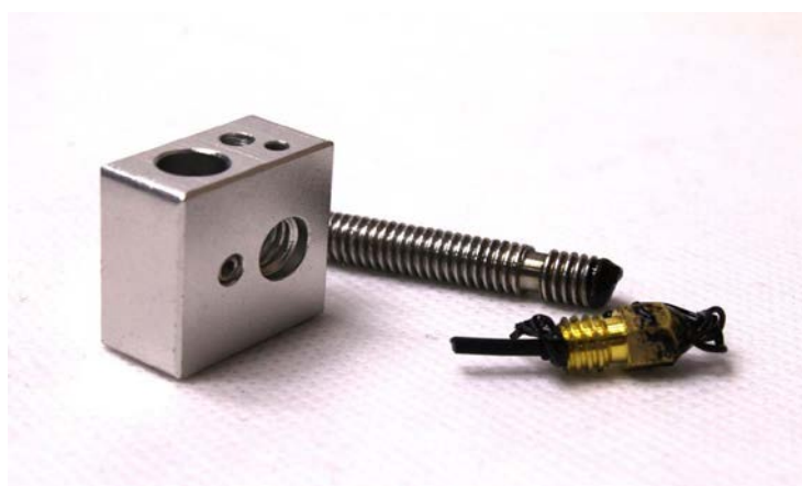
Figura 2-13 Obstrucción en el extrusor. Temperatura de impresión incorrecta. [13]
