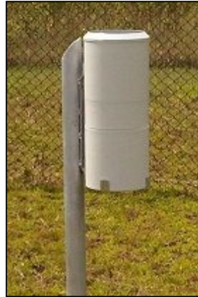
Figura 11. Pluviómetro Hellmann usado por AEMET para sus redes de observación.
