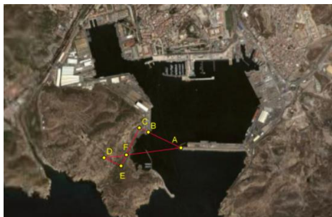
Ilustración 5: Uso de Trigonometría en la construcción de un túnel a través de las montañas para calcular la dirección exacta por la que el túnel debe de salir en el otro lado; Fuente: Rojas, 2015.
