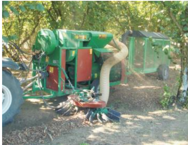
Ilustración 1.3.11 Cabezal de aspiración (FACMA, 2018).
