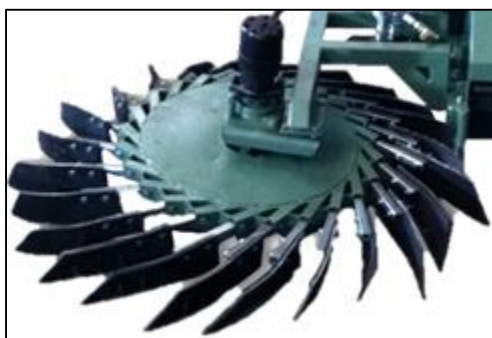
Ilustración 2.5.2 Cepillo con escobillas de goma (Garriga, Industrias Garriga , 2018)
