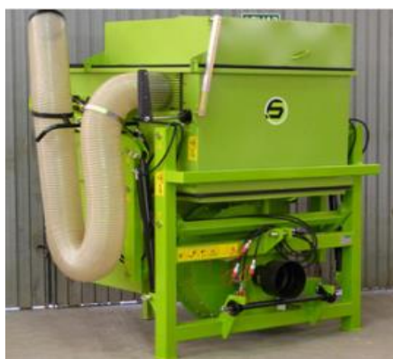
Ilustración 1.3.2 Diseño del aspirador (Agarín, Agarín, 2018).
