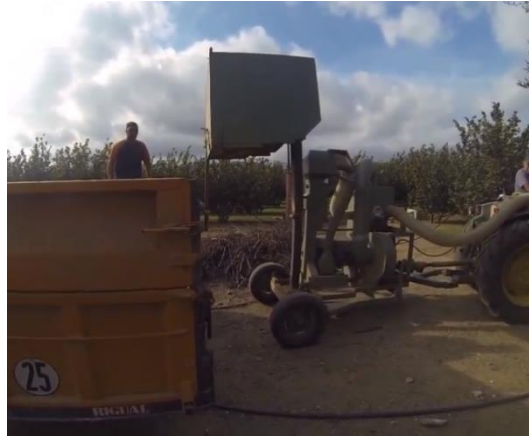
Ilustración 1.3.4. Máquina recolectora y clasificadora de frutos (Garriga, Industrias Garriga, 2018).
