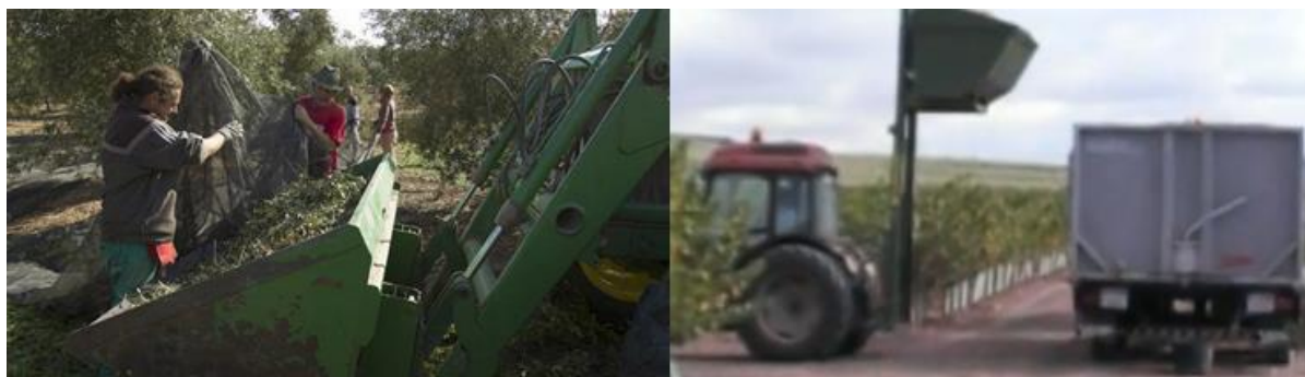
Ilustración 1.1.7 Uso de elevadores con cazo en la recolección
