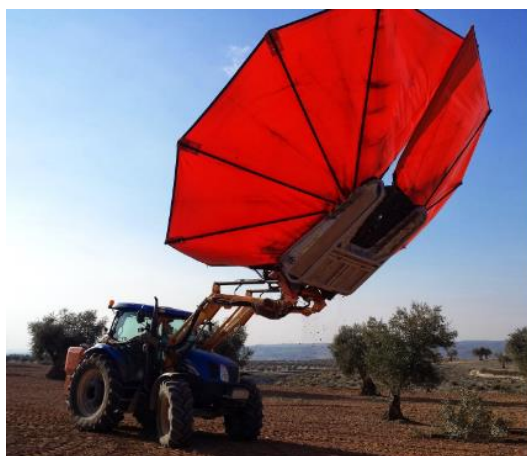
Ilustración 1.1.8 Paraguas vibrador en la disposición de descarga
