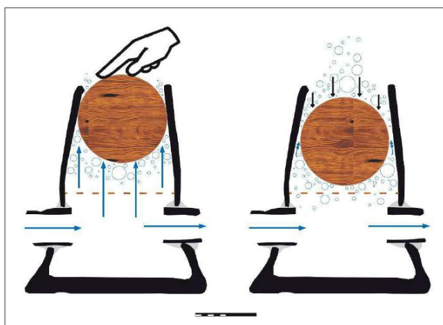
Figura 50. Recreación del funcionamiento de una válvula ventosa romana.
