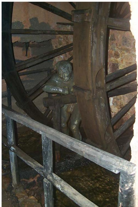
Foto reproducción del funcionamiento de una noria y la posición que adoptaría el minero (Museo de Riotinto, Huelva)
