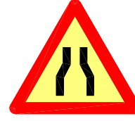
TP-17 ESTRECHAMIENTO DE CALZADA
