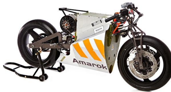
Figura 54.- Chasis con caja de baterías como elemento estructural en motocicleta eléctrica 56
