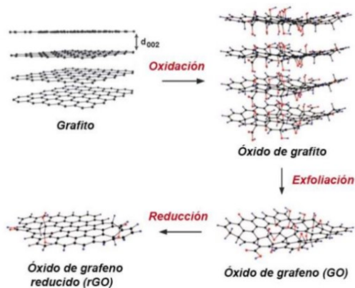
Figura 3.5. Ruta del óxido de grafito para la síntesis de grafeno. (Rozada-Rodríguez, 2014)
