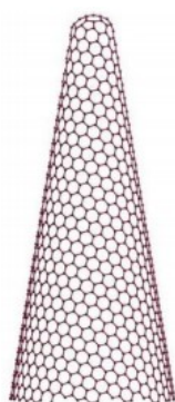
Figura 3.8. Estructura de los nanocuernos de carbono.
