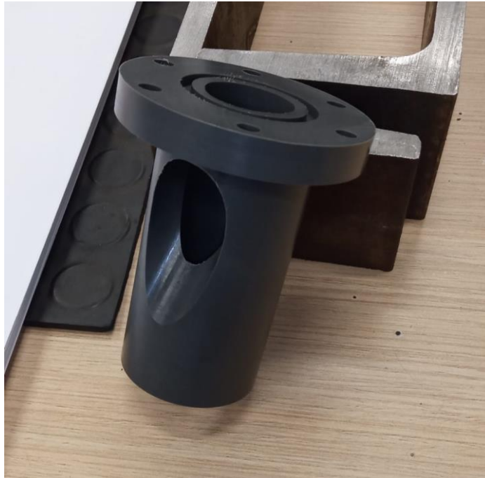
Ilustración 48: Detalle del taladro inclinado (EPS Linares)
