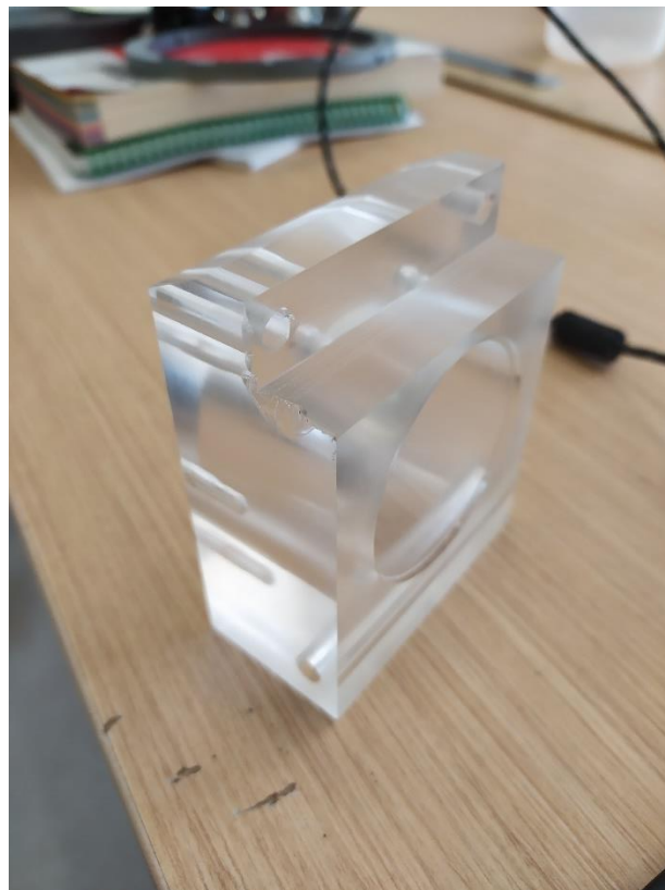
Ilustración 41: Desprendimiento lateral del material (EPS Linares)
