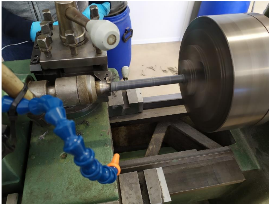
Ilustración 46: Cuerpo principal de la aguja (pvc) con detalle de torneado (EPS Linares)
