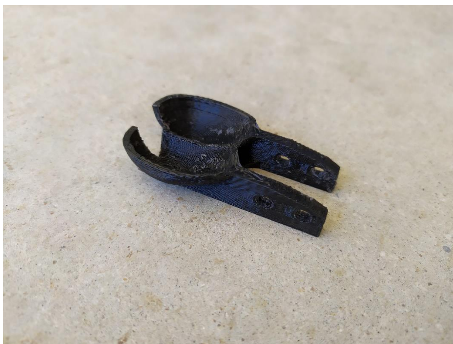
Ilustración 52: Pala después del lijado (EPS Linares)
