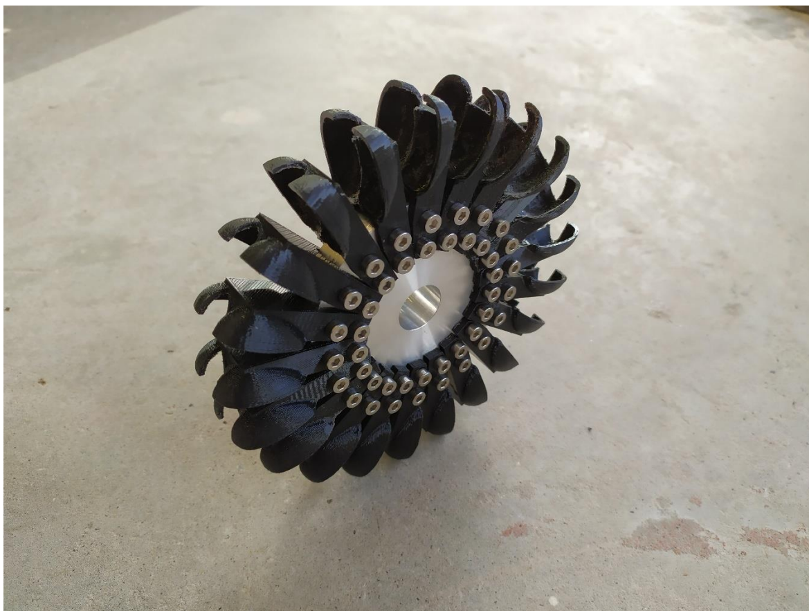
Ilustración 54: Montaje rodete y palas (EPS Linares)
