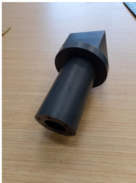
Ilustración 47: Cuerpo principal con mecanizado básico (EPS Linares)
