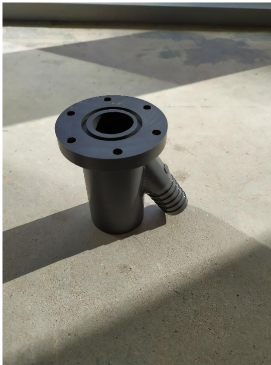
Ilustración 49: Resultado final del cuerpo principal del inyector (EPS Linares)
