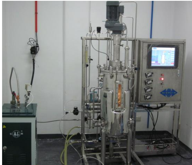
Ilustración 15. Biorreactor de 316 L desarrollado por (Actiu, 2022) Beijin Sentinain Technology Inc.
