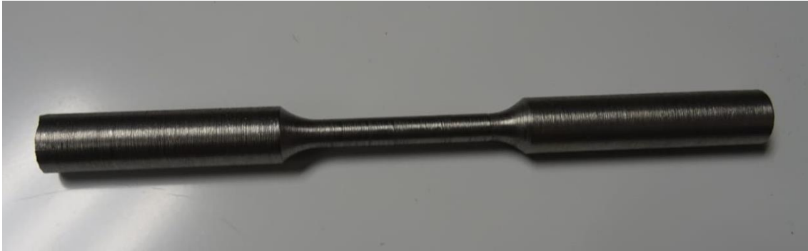
Imagen 1.13 - Probeta de tracción normalizada de 6 mm de diámetro
