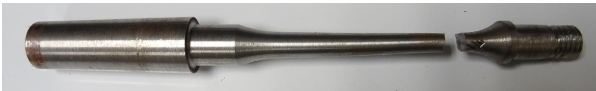
Imagen 2.30 - Probeta tras el ensayo con 290,85 MPa
