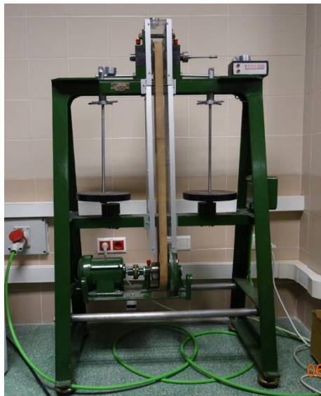
Imagen 1.1- Máquina de flexión rotativa
