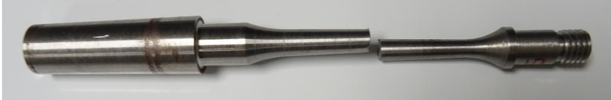
Imagen 2.28 - Probeta tras el ensayo con 326,03 MPa
