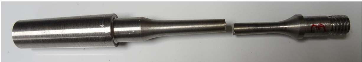
Imagen 2.23 - Probeta tras el ensayo con 436,31 MPa
