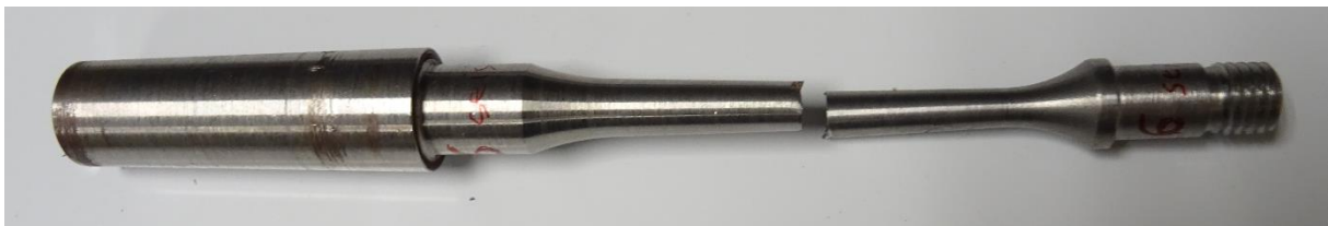
Imagen 2.24 - Probeta tras el ensayo con 392,38 MPa
