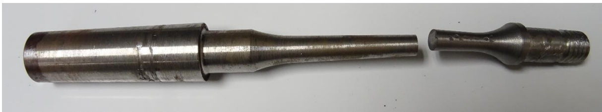
Imagen 2.26 - Probeta tras el ensayo con 370,26 MPa
