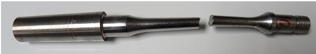
Imagen 2.27 - Probeta tras el ensayo con 326,03 MPa
