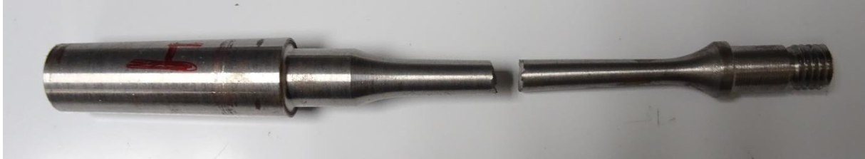
Imagen 2.25 - Probeta tras el ensayo con 370,26 MPa
