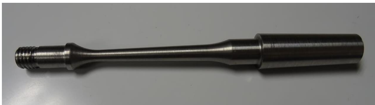
Imagen 1.15 - Probeta cónica para flexión rotativa con un diámetro de rotura de 7,62 mm
