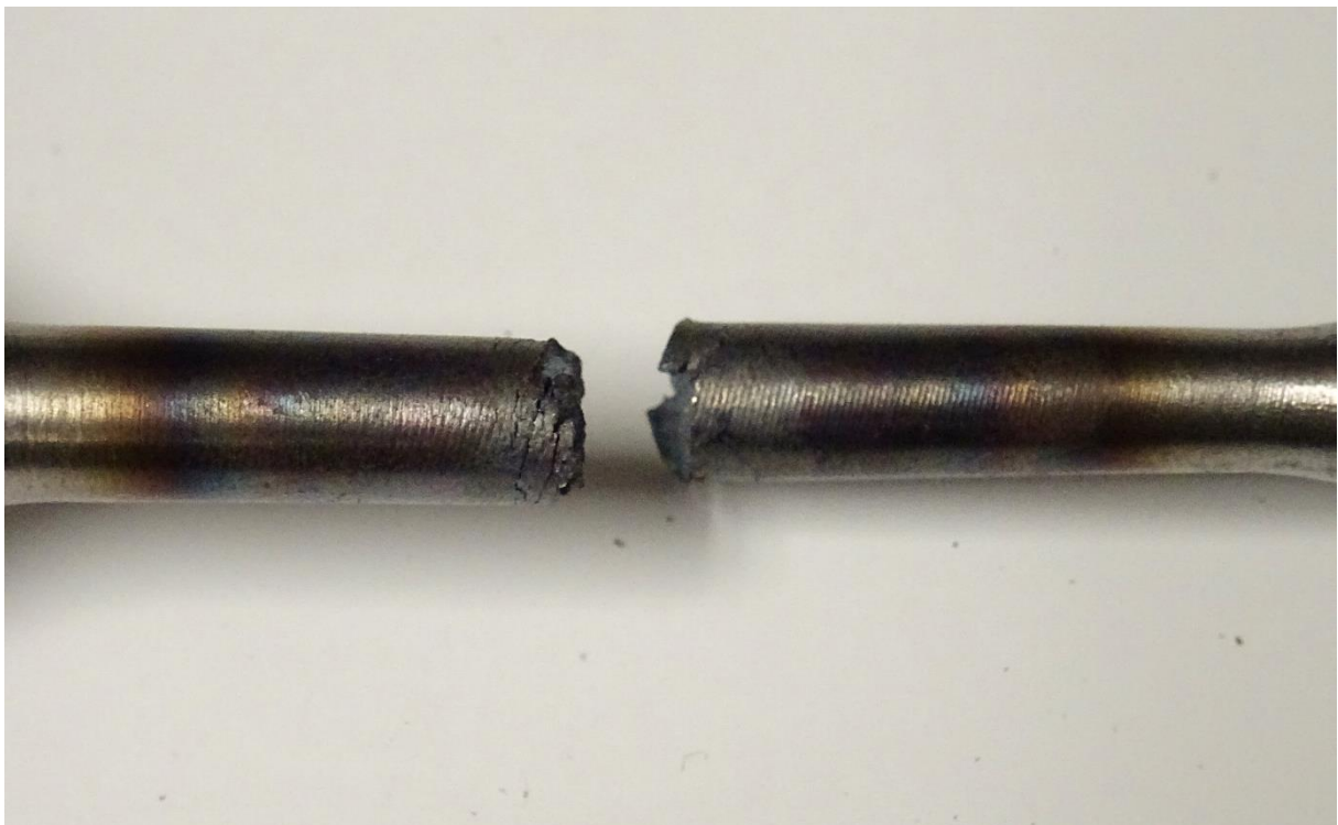
Imagen 1.24 - Probeta afectada por la temperatura debido a altas cargas
