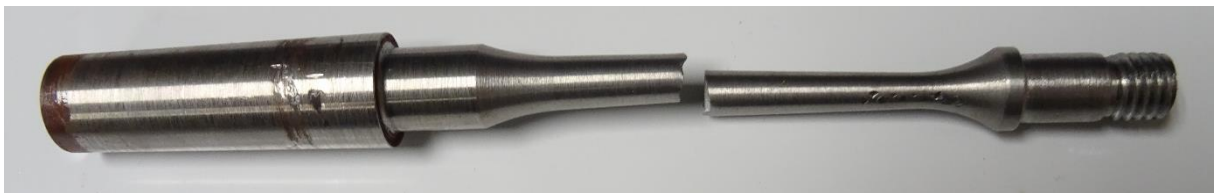
Imagen 2.29 - Probeta tras el ensayo con 297,27 MPa
