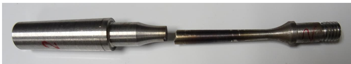
Imagen 2.21 - Probeta tras el ensayo con 591,44 MPa
