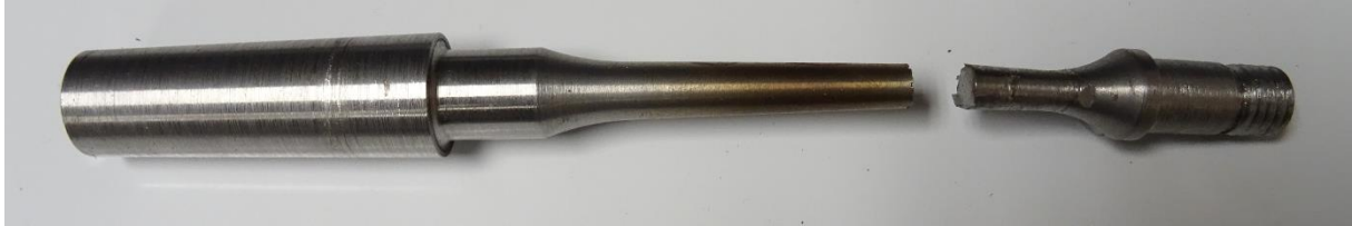
Imagen 2.22 - Probeta tras el ensayo con 480,85 MPa
