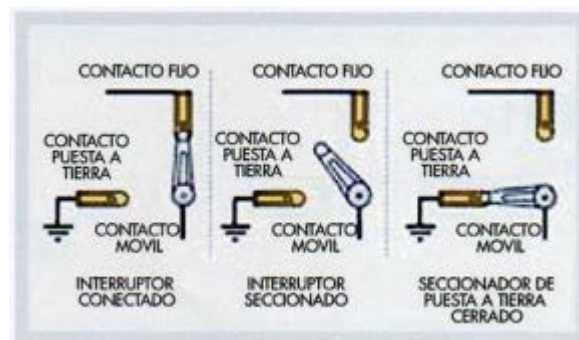
Figura 7. Funcionamiento del interruptor
