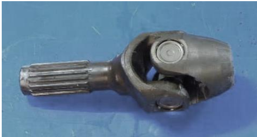
Figura 4.2.1.3 Acoplamiento a la propulsión trasera
