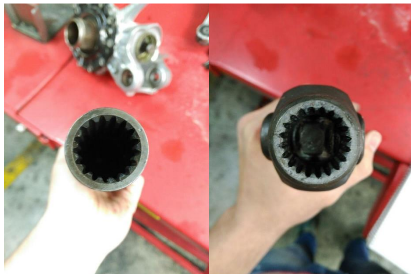
Figura 4.2.1.4 Detalle de acoplamientos mediante ejes y cubos nervados
