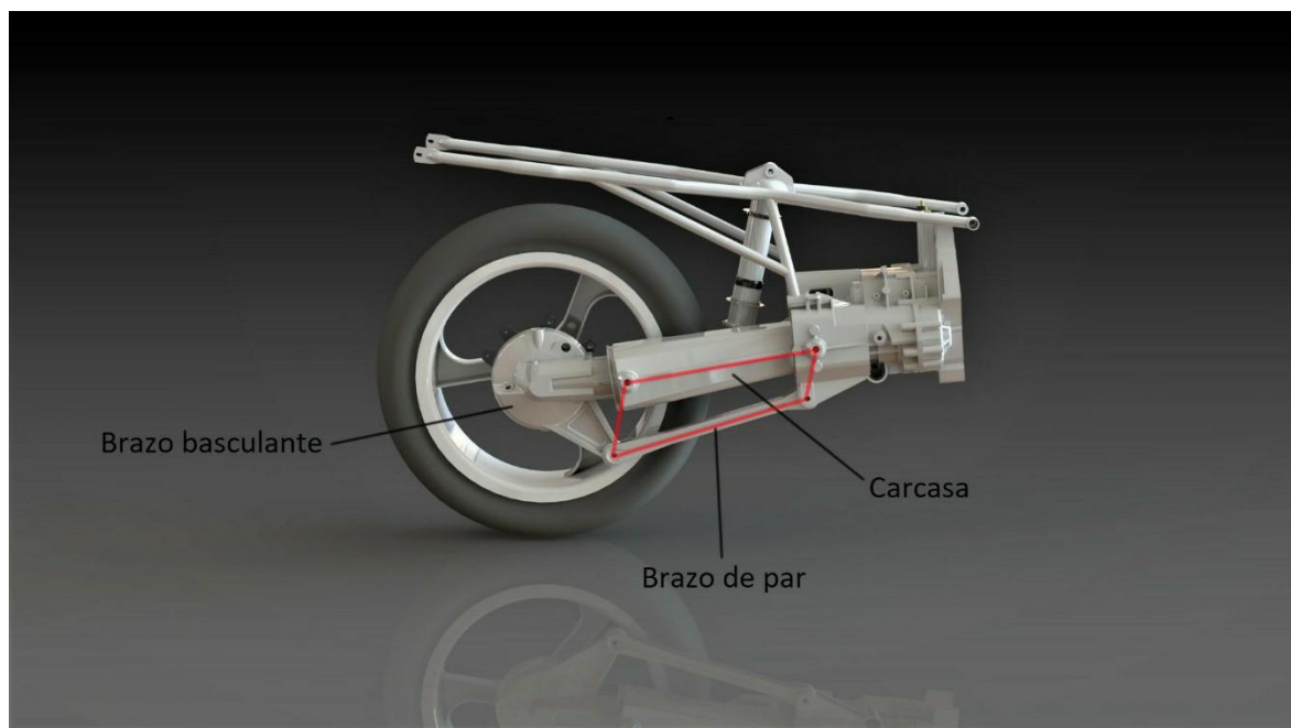
Figura 2.2.1 Sistema Paralever (paralelogramo representado en rojo)
