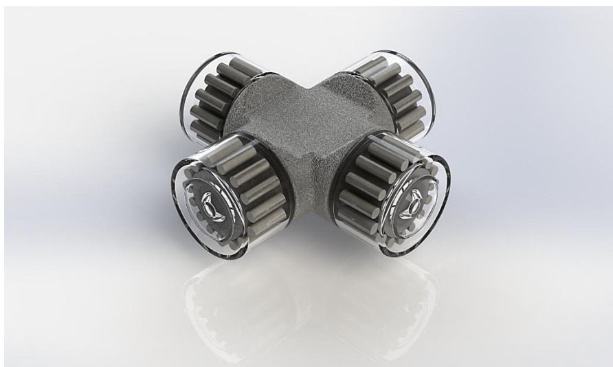
Figura 4.2.1.8 Junta Cardan (casquillos transparentes para visualizar las agujas)
