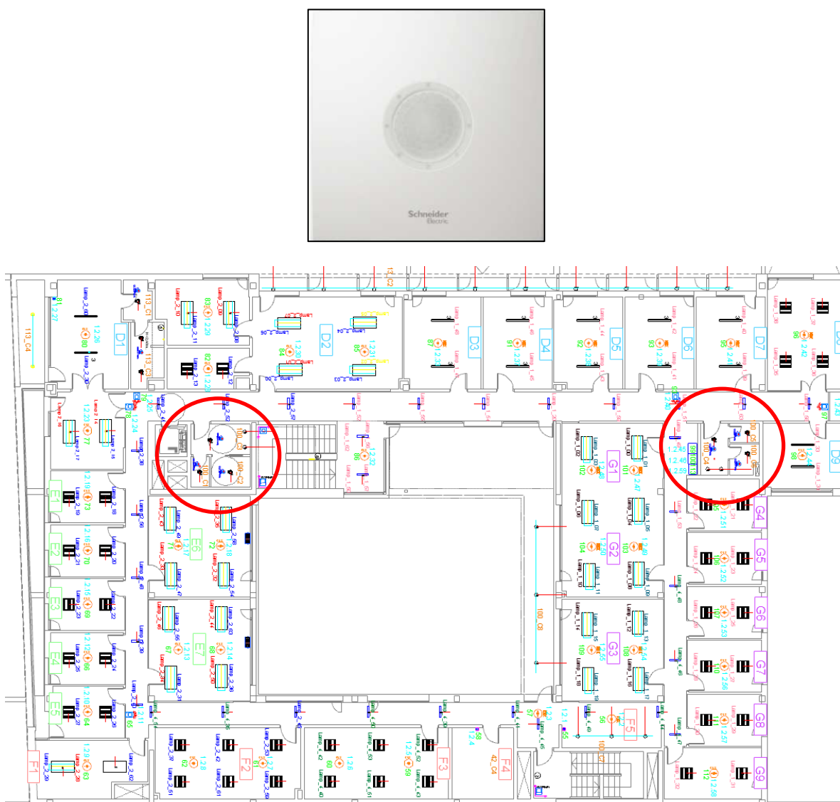
Figura 7.23 y 7.24 Detector de movimiento CCT56P002 ARGUS estándar interior 360° en planta primera
