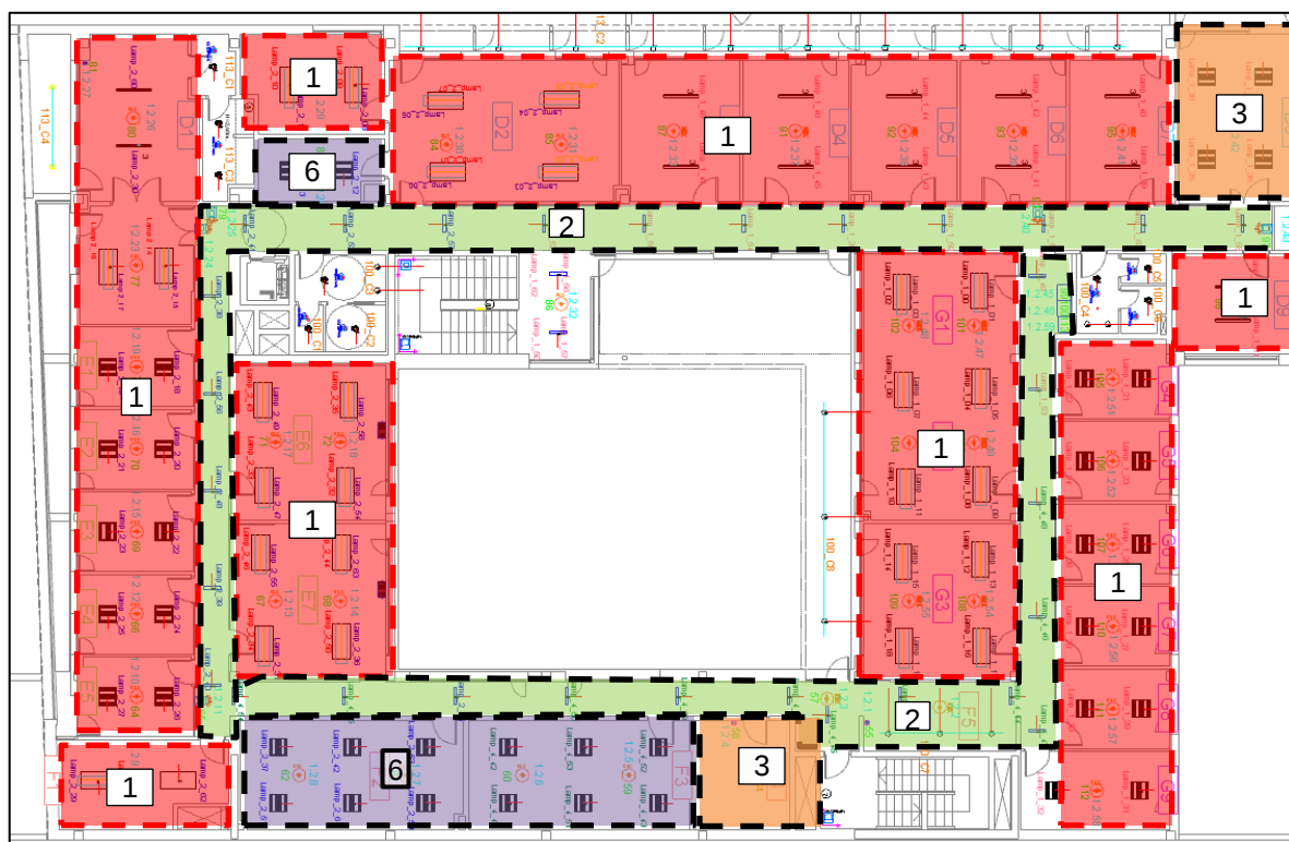
Imagen 7.38. Planta Primera. Zonas actuadas con KNX
