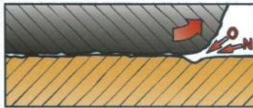
Figura 2.12.-Mecanismo de desgaste. Reacciones químicas.
