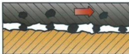
Figura 2.10-Mecanismo de desgaste. Abrasión.
