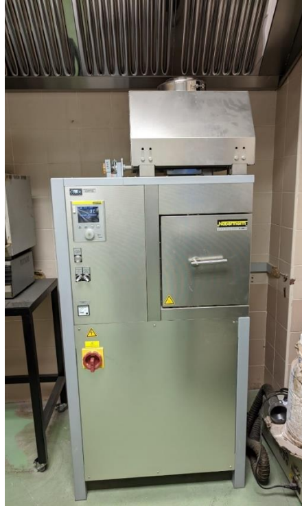
Ilustración 10. Horno de altas temperaturas utilizado
