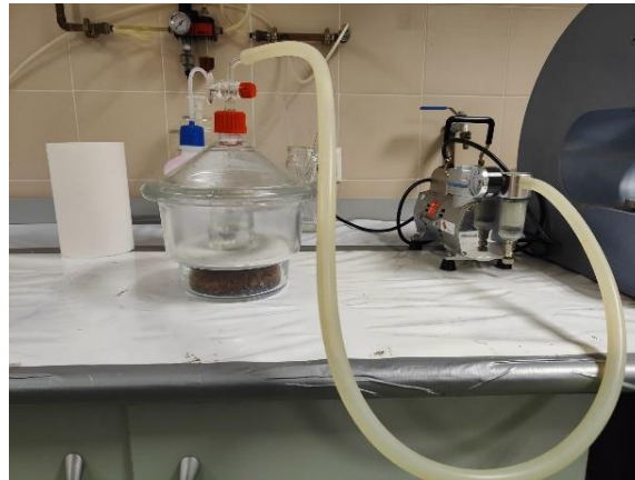
Ilustración 13. Bomba de vacío y desecador utilizados
