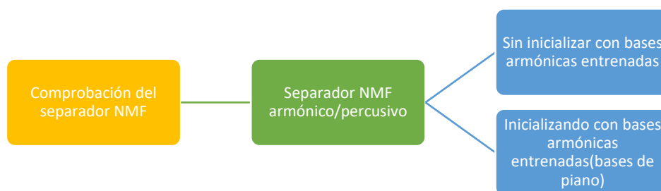
Figura 4.42: Esquema del sistema NMF armónico/percusivo que permite comprobar el funcionamiento del sistema de separación NMF
