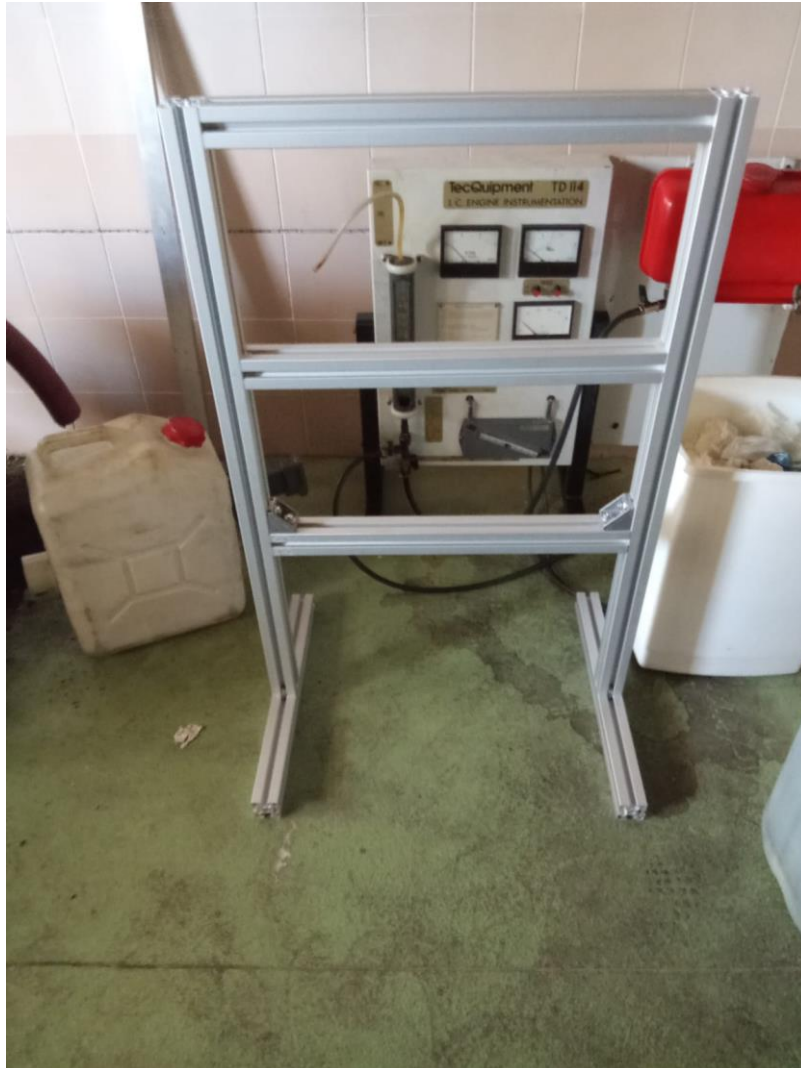
Figura 4.1 Estructura/soporte de la instalación
