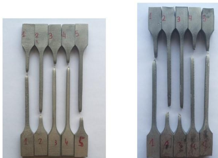
Ilustración 4.1.4.4. Probetas tipo hueso del alma (izq.) y ala (der.) después de los ensayos.
