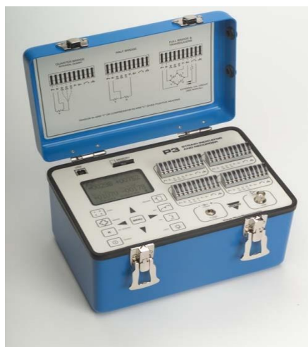
Ilustración 4.1.3.2. Equipo de medición P3 Strain Indicator usado para las galgas.
