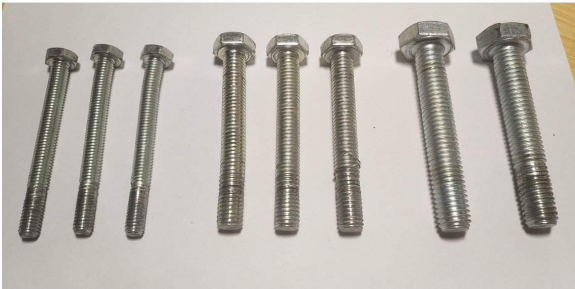
Ilustración 5.2.5.4. Tornillos de los especímenes después de los ensayos.
