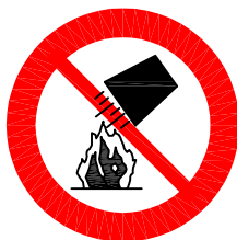
PROHIBIDO APAGAR CON AGUA
