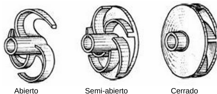
Figura 5.12: Tipología de rodetes para bombas centrífugas
