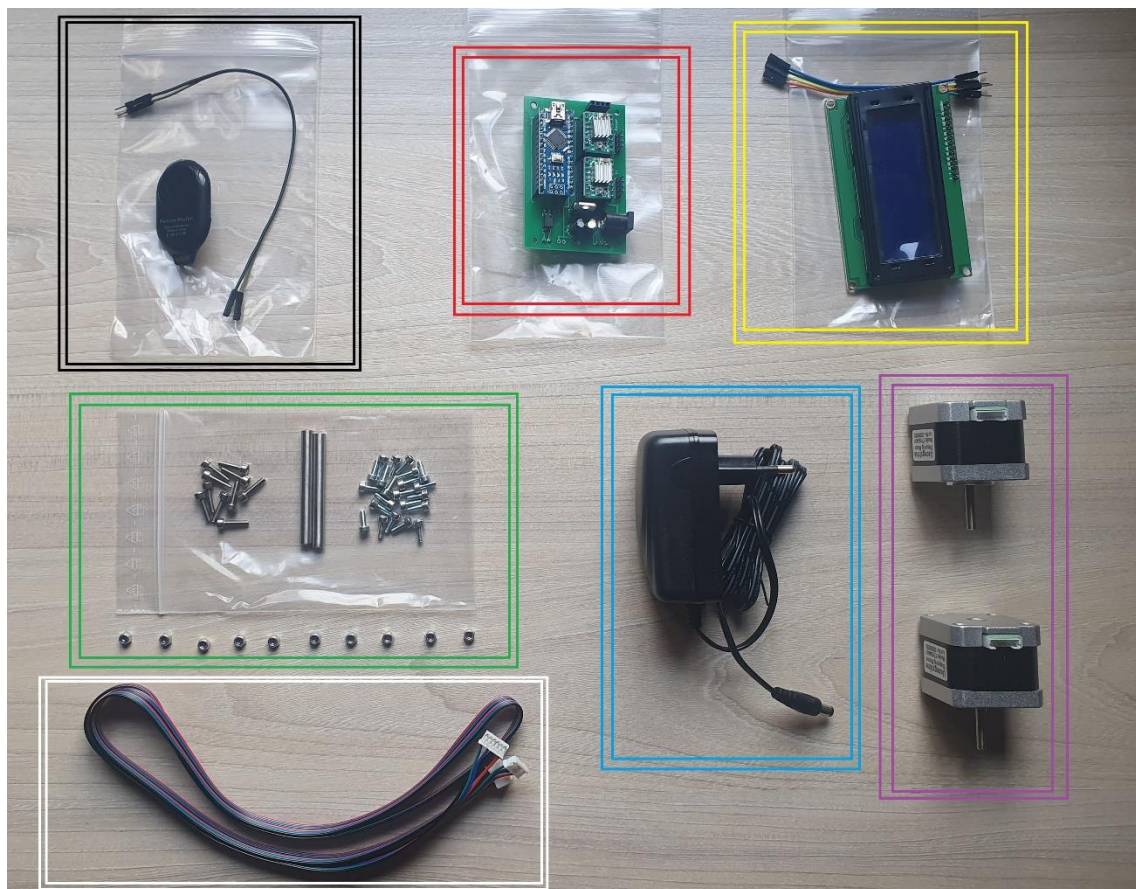
Ilustración 17: Componentes electrónicos del escáner 3D
