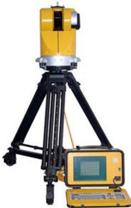
Ilustración 7: Escáner de tiempo de vuelo [10]
