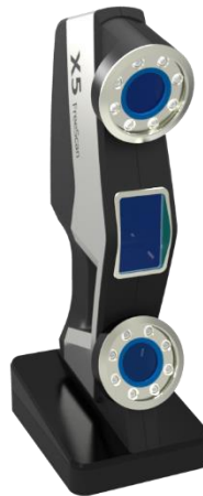
Ilustración 10: Escáner láser de luz modulada [14]
